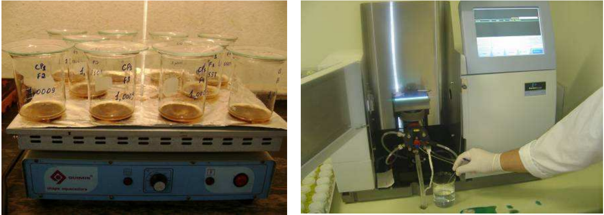
Figura 20: (a) Extração por digestão ácida das amostras de solo e (b) Análise de metais em espectrofotômetro de absorção atômica
