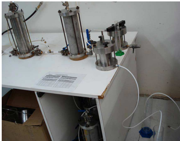
Figura 19: Etapa de saturação dos corpos de prova e medição da condutividade hidráulica
