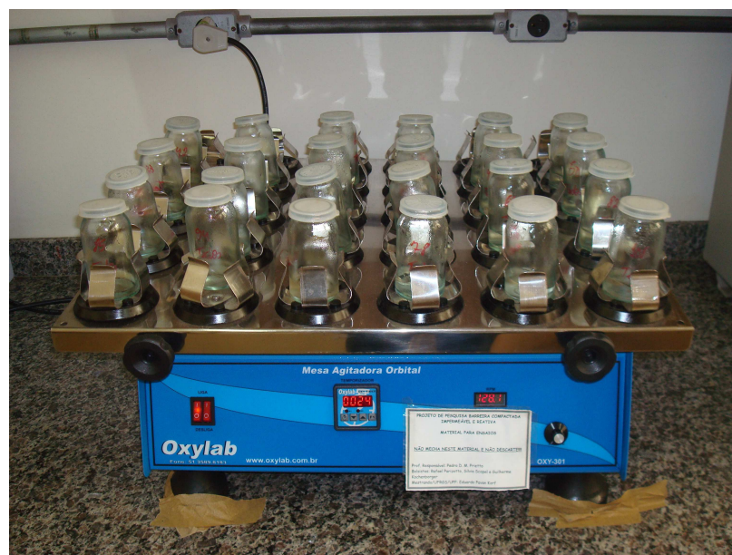
Figura 21: Realização de ensaio de batelada
