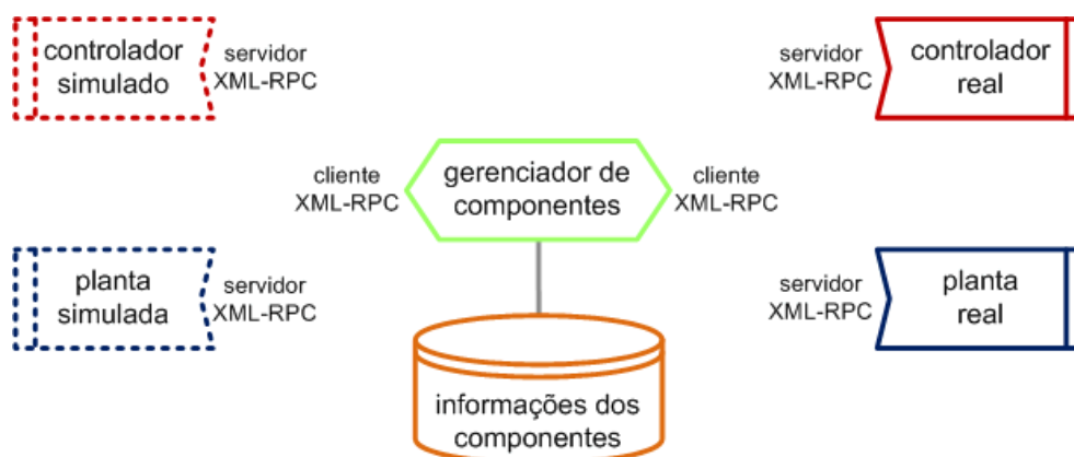
Figura 52: Implementação dos componentes intercambiáveis - diagrama de comunicação.
