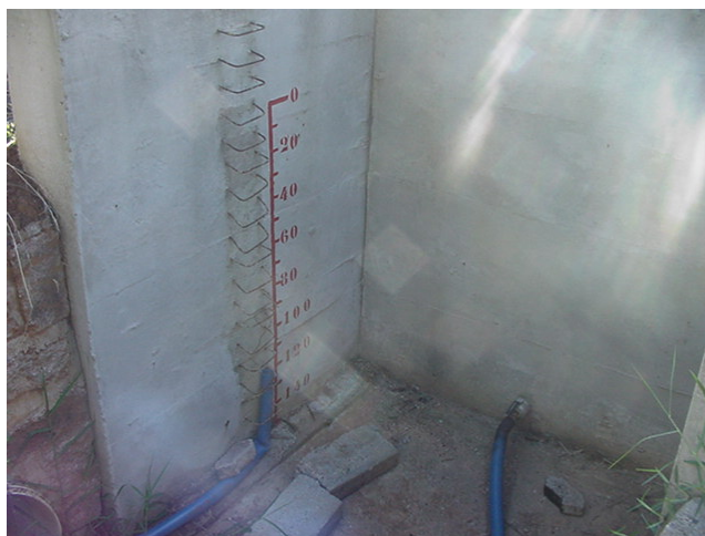
Figura 6.12: Dispositivo para controle do nível d'água no dreno, estágio 1 (NA na cota -1,2 m), desta pesquisa
