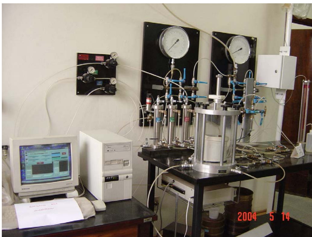
Figura 4.2: Ilustração do ensaio de condutividade hidráulica do solo da CFT utilizado nesta pesquisa
