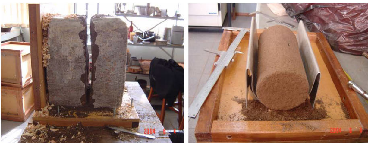
Figura 4.7: Preparação do corpo de prova indeformado do solo do subleito para o ensaio de módulo de resiliência
