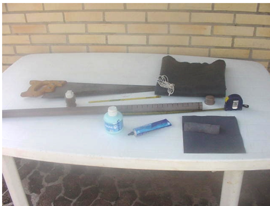
Figura 3.37: Materiais utilizados na confecção dos piezômetros instalados nas pistas experimentais desta pesquisa
