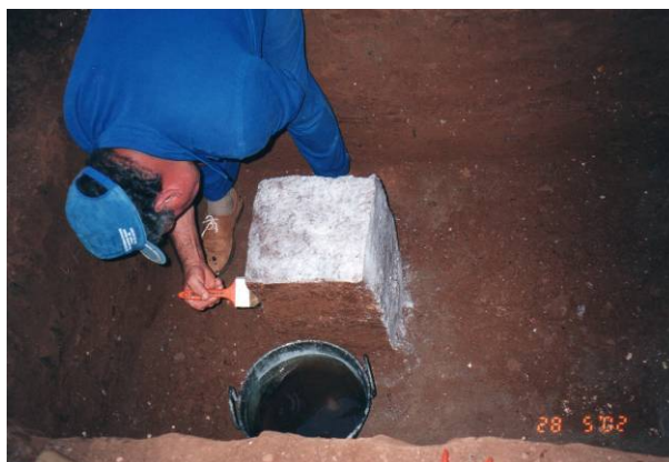
Figura 3.9: Bloco indeformado parcialmente parafinado
