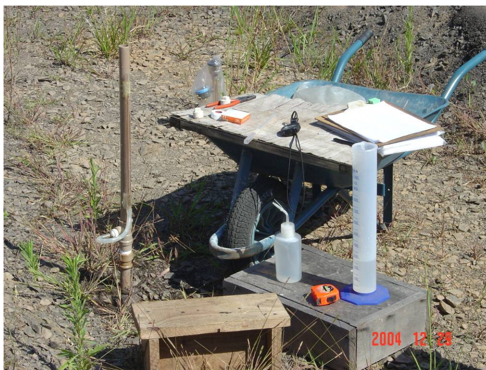
Figura 3.46: Aspecto do ensaio com o piezômetro com bureta realizado no canteiro central das pistas experimentais desta pesquisa
