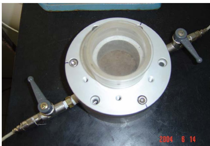
Figura 4.4: Ilustração do aparelho de placa de sucção usado no ensaio do subleito nesta pesquisa
