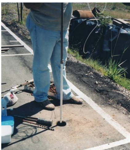
Figura 3.40: Ilustração de um tensiômetro com manômetro de mercúrio nas pistas experimentais desta pesquisa
