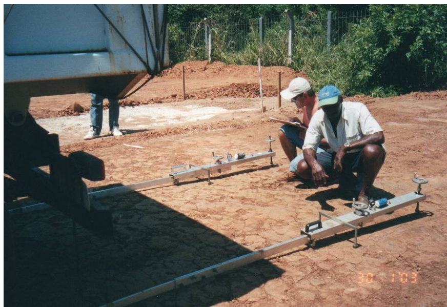
Figura 3.23: Avaliação da deformabilidade elástica com a viga Benkelmann no topo da CFT nas pistas desta pesquisa
