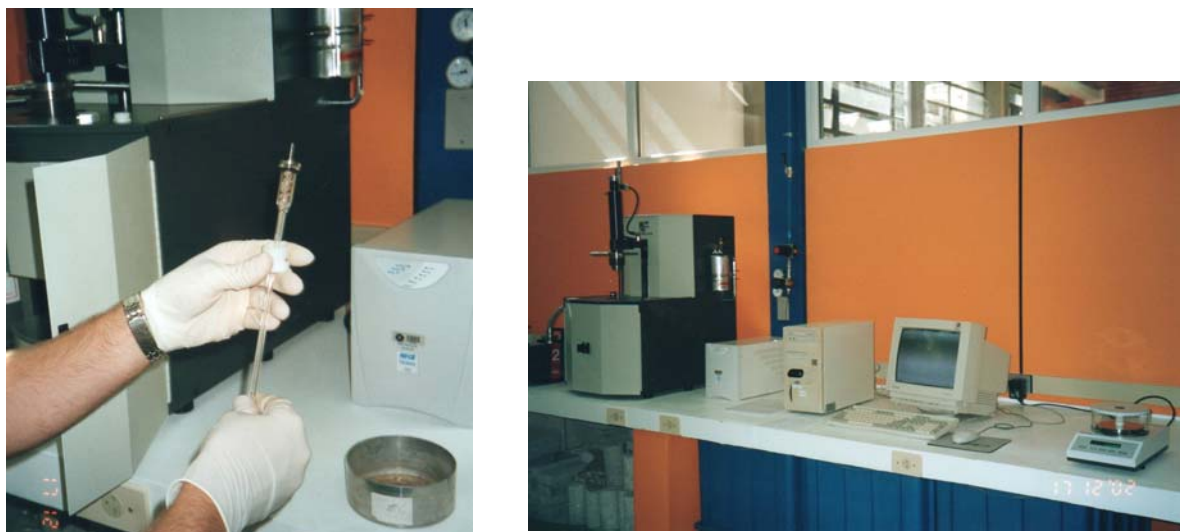
Figura 4.9: Porosimetria por intrusão de mercúrio do solo da CFT estudado nesta pesquisa, ensaio realizado na UNISINOS
