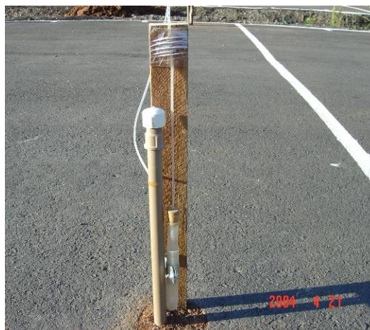
Figura 3.40: Ilustração de um tensiômetro com manômetro de mercúrio nas pistas experimentais desta pesquisa
