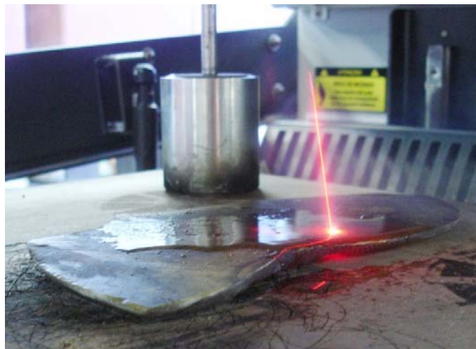
Figura 56: Processo de corte a laser em chifre, com refrigeração
