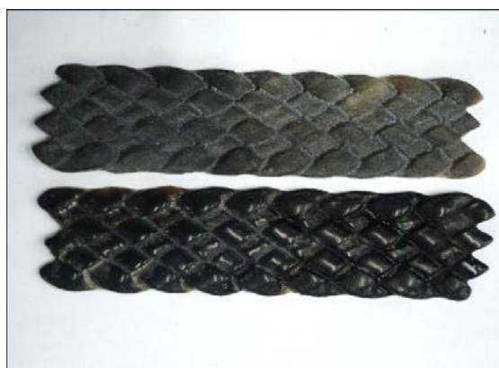
Figura 55: Trama usinada em chifre sem polimento (em cima) e com polimento (embaixo)
