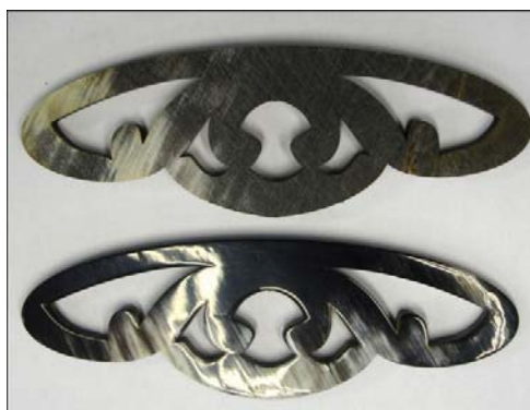
Figura 58: Chifres cortados a laser, sem polimento (em cima) e polido (embaixo)
