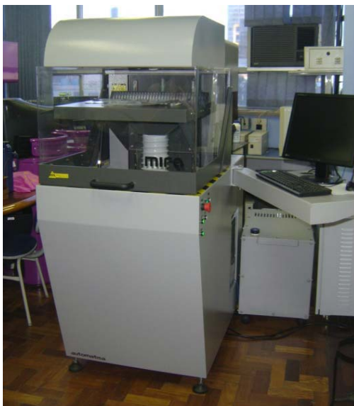
Figura 34: Equipamento de corte e gravação a laser Mira, da Automatisa, pertencente ao LdSM
