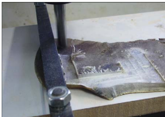
Figura 49: Chifre em processo de usinagem para planificação da superfície
