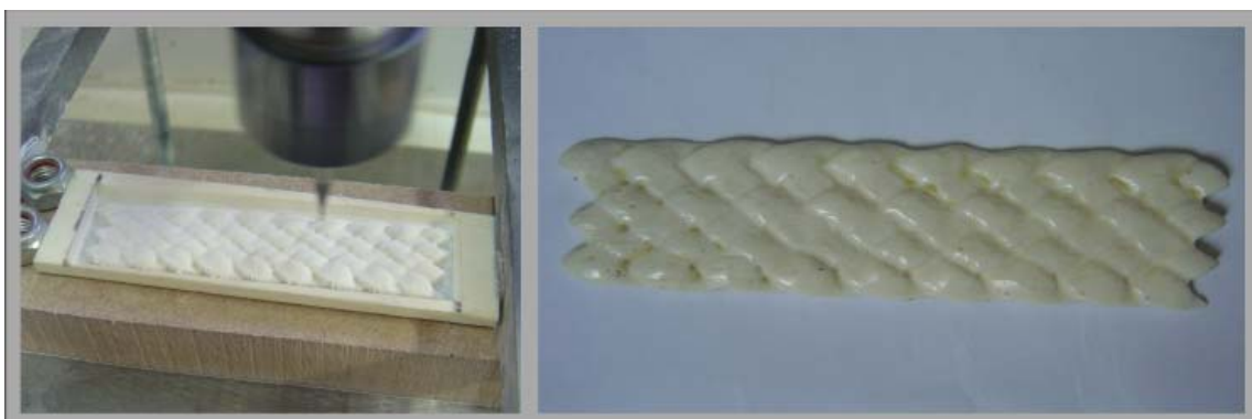
Figura 54: Usinagem em osso, da trama digitalizada (direita); peça acabada, com polimento (esquerda)
