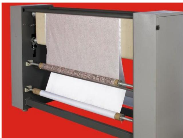
Figura 35 – Máquina para serigrafia corrida de sublimação – Disponível em <http://www.mogk.com.br/produto/106/maquina-para-transfer-continuo>
