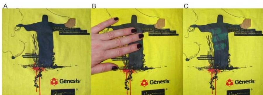
Figura 73 – Amostra da aplicação da Tinta Plastisol Termocrômico Preto em “bandeira” 100% algodão, sobrepondo desenho com tinta serigráfica comum, produzida pela Gênesis Tintas (2008) – A, B e C: Antes, durante e depois do estímulo de aquecimento — Imagens do arquivo pessoal do autor desta dissertação
