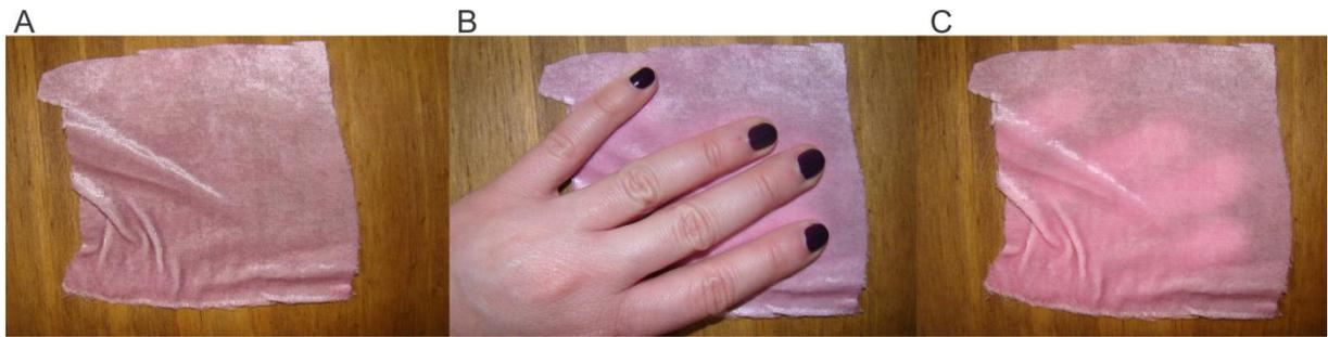
Figura 76 – Amostras de Tingimento Termocrômico em tecido sintético, onde: A) Tecido com tingimento termocrômico exposto à temperatura ambiente; B) Aquecimento com calor do corpo e; C) Resultado do estímulo de aquecimento do tecido. – Fabricação BASF – Imagens do arquivo pessoal do autor desta dissertação.
