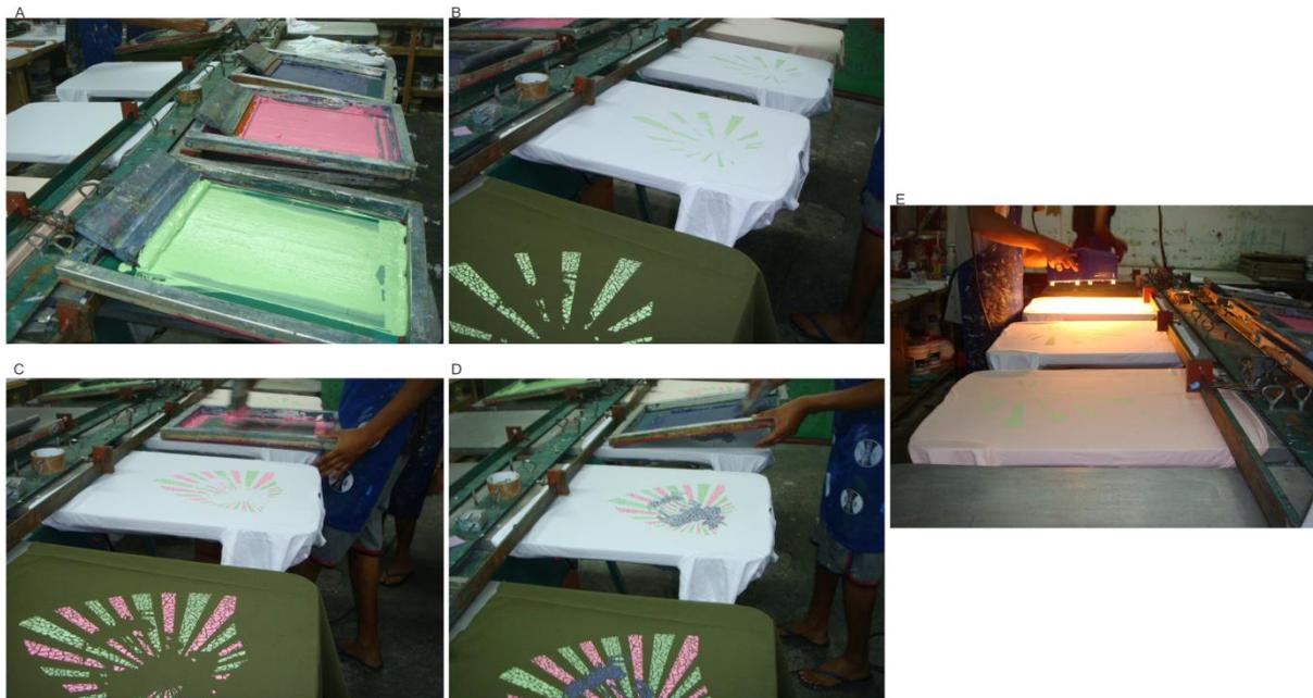
Figura 89 – A) Aplicação da estampa em tinta colorida; B, C e D) As três etapas de cores aplicadas na estampa e; E) A cura com *flash cure* – Imagens do arquivo pessoal do autor desta dissertação
