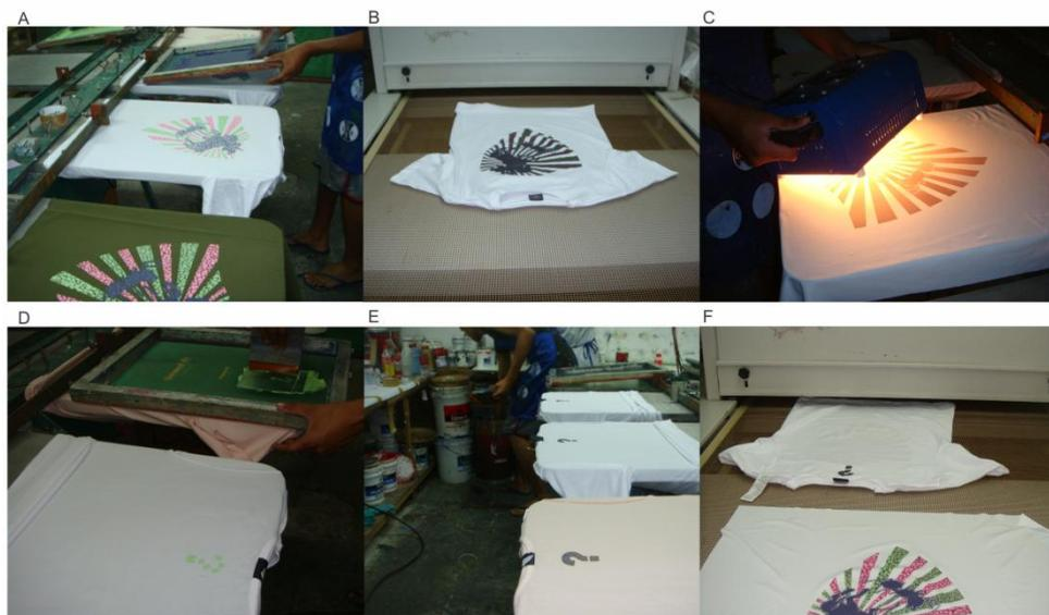
Figura 91 – A) Aplicação da Tinta Plastisol Termocrômico Preto; B) Cura com *flash cure*; C e F) Entrada da esteira de secagem e polimerização; D e E) Aplicação da estampa e da Tinta Plastisol Termocrômico Preto na parte interna das costas da camiseta. – Imagens do arquivo pessoal do autor desta dissertação.
