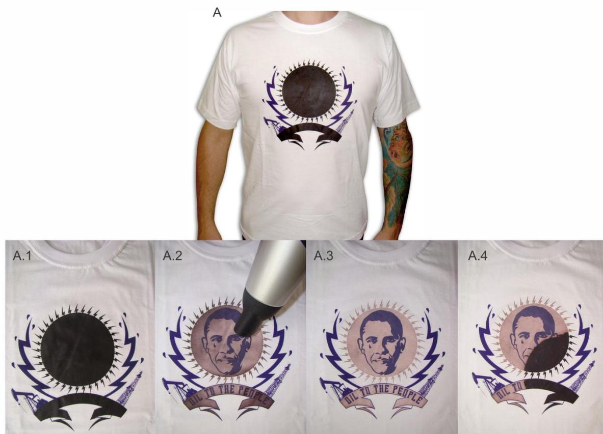
Figura 83 – A) Camiseta com aplicação de tinta Sericryl Termocrômico Preto; A.1) Estampa com tinta termocrômica em estado normal; A.2) Estampa sendo aquecida; A.3) Estampa após o aquecimento, revelando o desenho que estava por baixo; A.4) Contraste entre a área aquecida e área resfriada na estampa. – Imagens do arquivo pessoal do autor desta dissertação.
