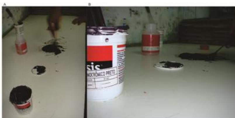
Figura 90 – A e B) Mistura do Plastisol Termocrômico Preto, com Amaciante para Plastisol e Sericryl Termocrômico Preto – Imagens do arquivo pessoal do autor desta dissertação
