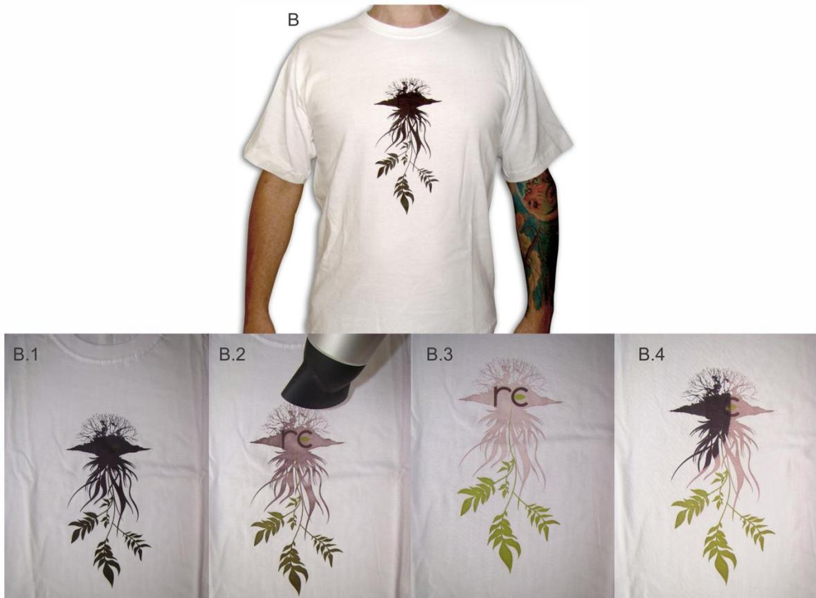
Figura 84 – B) Camiseta com aplicação de tinta Sericryl Termocrômico Preto; B.1) Estampa com tinta termocrômica em estado normal; B.2) Estampa sendo aquecida; B.3) Estampa após o aquecimento, revelando o desenho que estava por baixo; B.4) Contraste entre a área aquecida e área resfriada na estampa. – Imagens do arquivo pessoal do autor desta dissertação.
