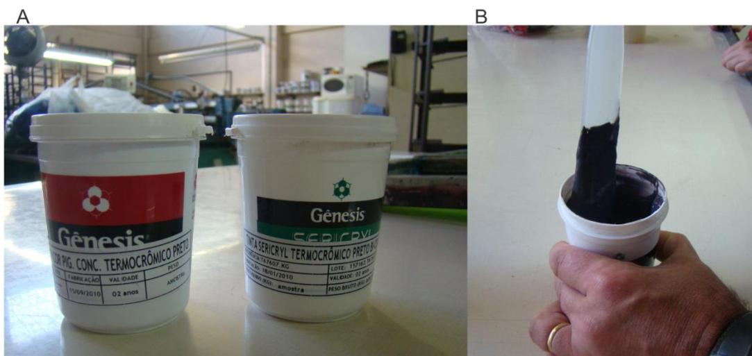
Figura 99 – A e B) Mistura do Sericryl Termocrômico Preto, com Sericor Pigmento Concentrado Termocrômico Preto – Imagens do arquivo pessoal do autor desta dissertação
