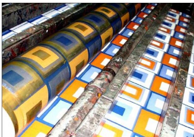
Figura 34 – Serigrafia corrida de Cilindro – Imagem disponível no sítio eletrônico <http://www.gtex.com.br/galeria/estamparia>
