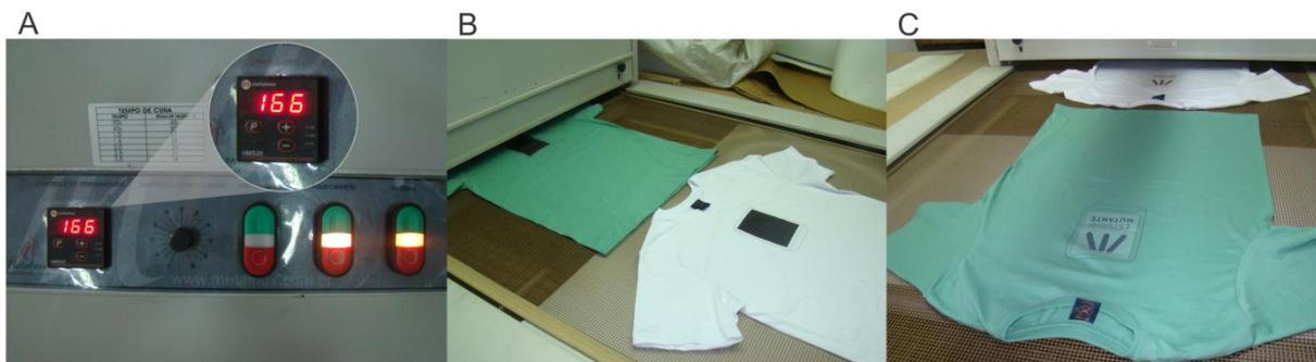
Figura 101 – A) Polimerizadeira configurada na temperatura de 166°C para secagem da tinta termocrômica; B) Entrada das camisetas na esteira da polimerizadeira e C) Saída das camisetas da esteira da polimerizadeira. – Imagens do arquivo pessoal do autor desta dissertação.
