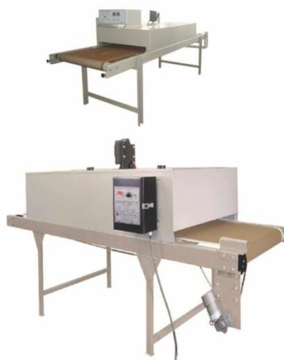
Figura 31 – Polimerizadeira para secagem de tinta serigráfica – Imagem disponível em <http://www.tupiscreen.com.br/estufa-e-polimerizadeira-com-esteira-66.html>
