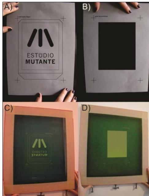
Figura 97 – A e B) Fitolitos impressos e C e D) Telas gravadas para serigrafia – Imagens do arquivo pessoal do autor desta dissertação.
