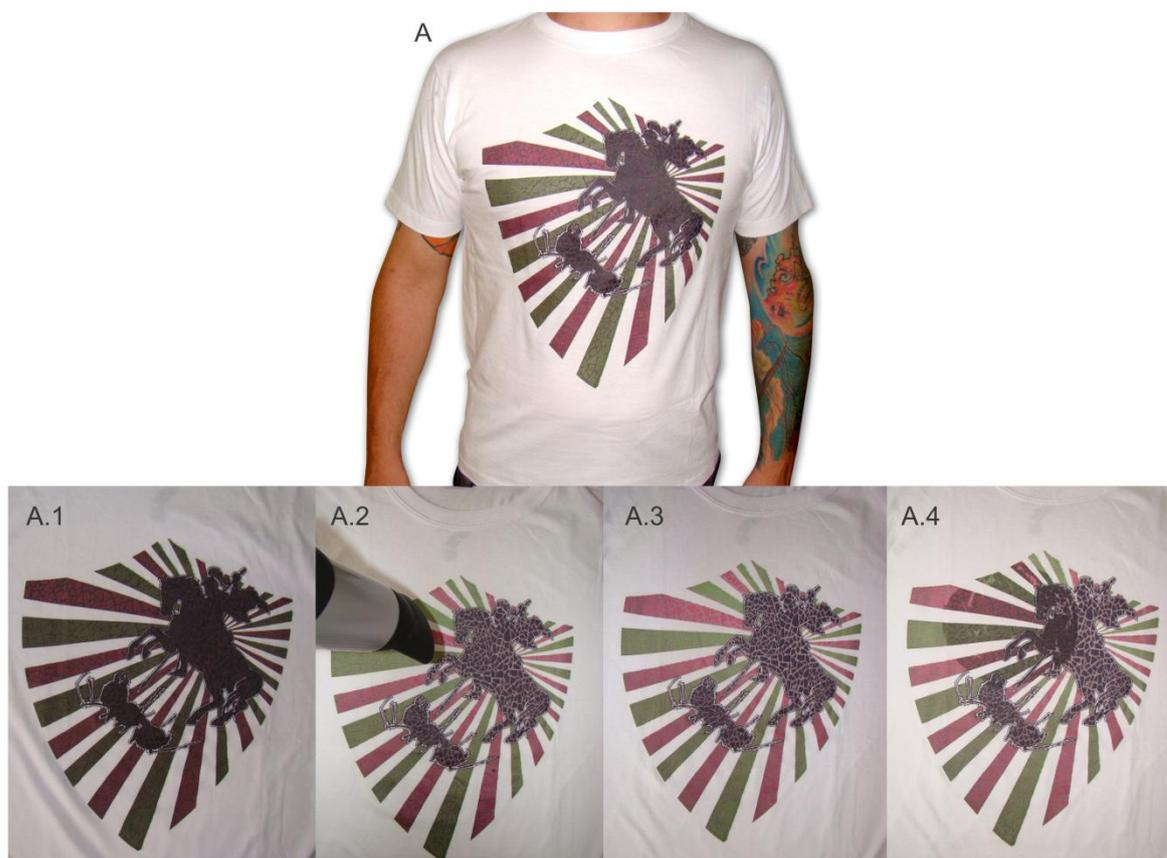
Figura 93 – A) Camiseta com aplicação de tinta Sericryl Termocrômico Preto; A.1) Estampa com tinta termocrômica em estado normal; A.2) Estampa sendo aquecida; A.3) Estampa após o aquecimento; A.4) Contraste entre a área aquecida e área resfriada na estampa. – Imagens do arquivo pessoal do autor desta dissertação.
