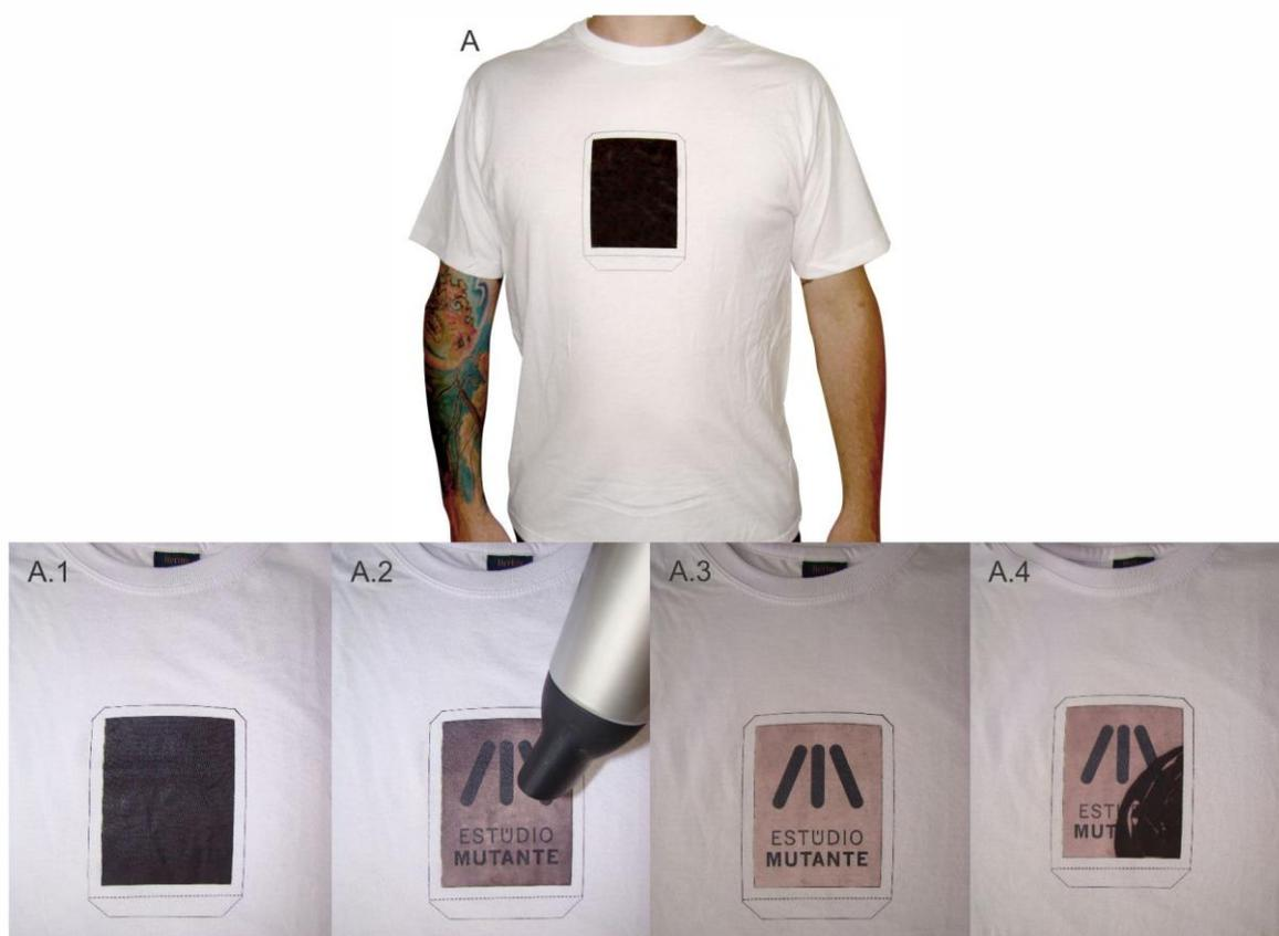
Figura 102 – A) Camiseta com aplicação de tinta Sericryl Termocrômico Preto sobrepondo estampa aplicada com tinta Sericryl comum; A.1) Estampa com tinta termocrômica em estado normal; A.2) Estampa sendo aquecida; A.3) Estampa após o aquecimento; A.4) Contraste entre a área aquecida e área resfriada na estampa. – Imagens do arquivo pessoal do autor desta dissertação.
