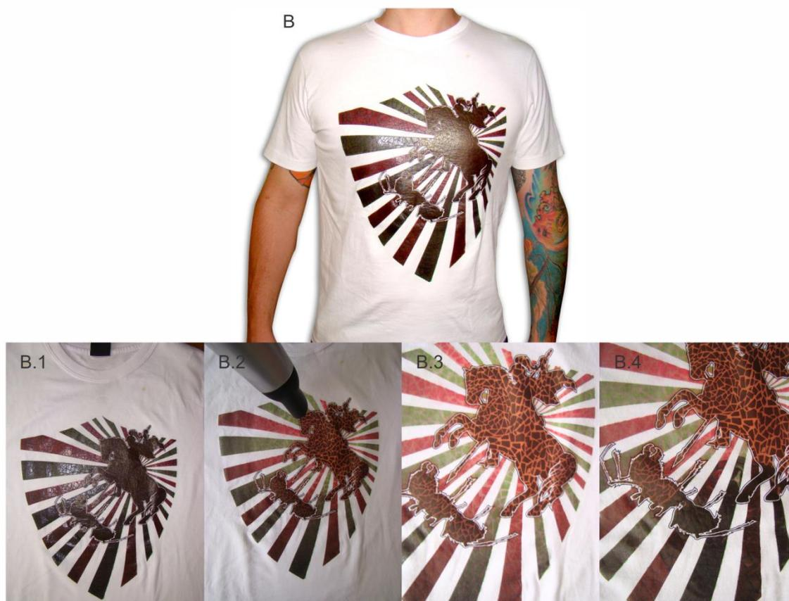
Figura 94 – B) Camiseta com aplicação de tinta Plastisol Termocrômico Preto; B.1) Estampa com tinta termocrômica em estado normal; B.2) Estampa sendo aquecida; B.3) Estampa após o aquecimento; B.4) Contraste entre a área aquecida e área resfriada na estampa.
