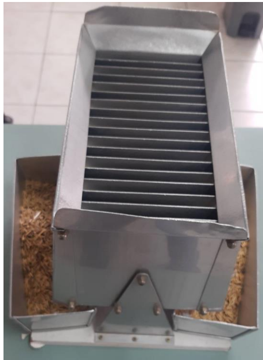
Figura 2 – Divisor de solos. Equipamento utilizado para obtenção da amostra de trabalho.
