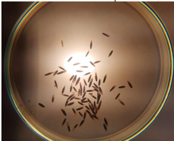
Figura 3 - Diafanoscópio. Equipamento utilizado para identificar sementes sem cariopse durante a análise de pureza.
