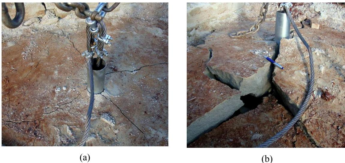
Figura 5.46: (a) avanço da fissuração na superfície e (b) ruptura total do reaterro de areia com 3% de cimento, para a fundação  $D = 30$  cm e  $H/D = 1,5$  (seqüência 3)
