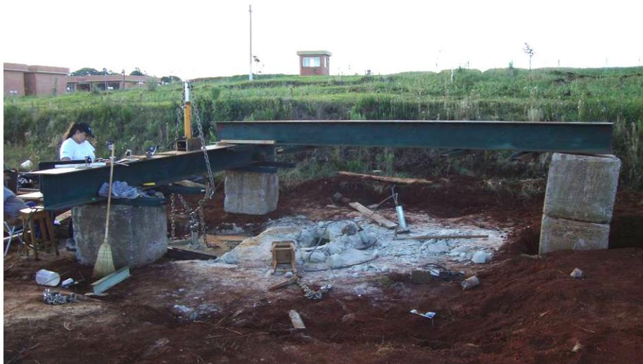
Figura 4.14: Fotografia do sistema de reação implantado em campo
