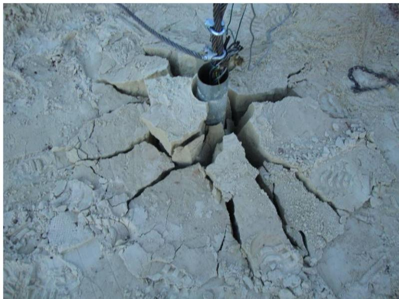
Figura 5.16: Superfície de ruptura circular, ( $D_f = 100,0$  cm) para areia sem cimento, fundação  $D = 30$  cm e  $H/D = 2,0$ , totalmente rompida
