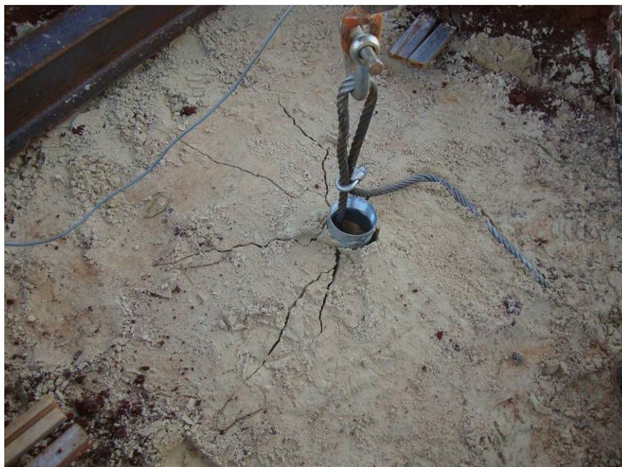
Figura 5.13: Superfície de ruptura circular, ( $D_f = 74,0$  cm) para areia sem cimento, fundação  $D = 30$  cm e  $H/D = 1,5$ , logo após a ruptura
