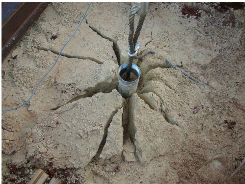
Figura 5.14: Superfície de ruptura circular, ( $D_f = 74,0$  cm) para areia sem cimento, fundação  $D = 30$  cm e  $H/D = 1,5$ , totalmente rompida
