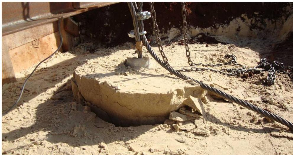
Figura 5.12: Vista lateral da superfície de ruptura (idem Figura 5.11 de outro ângulo) da prova de carga com areia sem cimento, fundação  $D = 30$  cm e  $H/D = 1,0$
