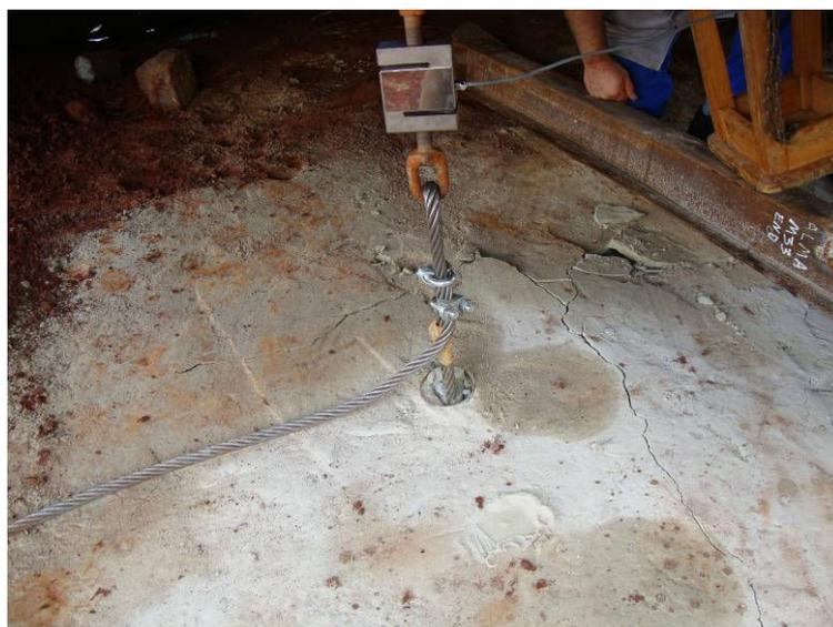
Figura 5.41: Avanço da fissuração na superfície do reaterro de areia com 3% de cimento, para a fundação  $D = 30$  cm e  $H/D = 0,5$  (seqüência 1)
