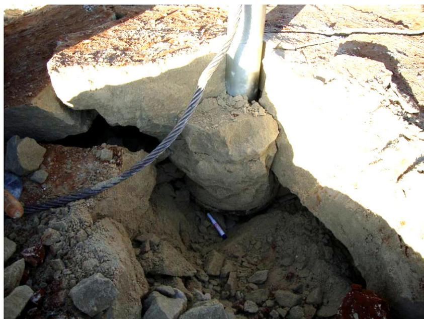
Figura 5.47: Vista lateral do reaterro de areia com 3% de cimento totalmente rompido, para a fundação  $D = 30$  cm e  $H/D = 1,5$  (seqüência 3)
