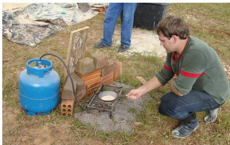
Figura 4.10: Ensaio da frigideira em execução
