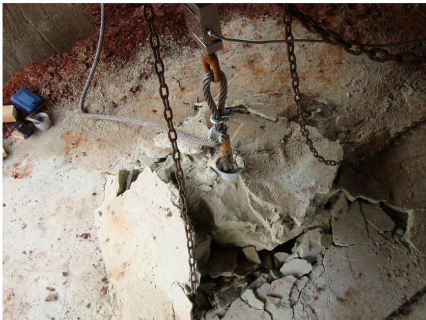
Figura 5.42: Reaterro de areia com 3% de cimento totalmente rompido, para a fundação  $D = 30$  cm e  $H/D = 0,5$  (seqüência 1)
