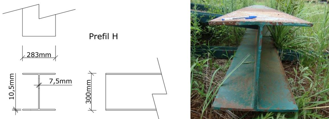
Figura 4.12: Fotografia e croqui com as dimensões da viga de reação composta por um perfil H de aço
