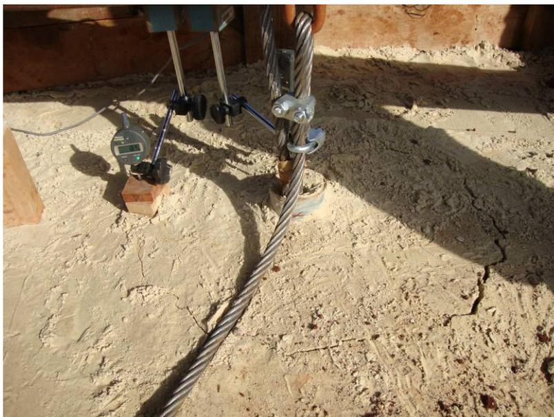
Figura 5.10: Superfície de ruptura circular ( $D_f = 54,0$  cm) para areia sem cimento, fundação  $D = 30$  cm e  $H/D = 1,0$ , logo após a ruptura
