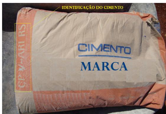
Figura 3.7: Fotografia de uma embalagem de 50kg do cimento CP-V ARI RS utilizado
