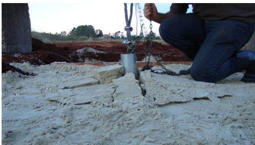
Figura 5.17: Vista lateral da superfície de ruptura (idem Figura 5.16 de outro ângulo) da prova de carga com areia sem cimento, fundação  $D = 30$  cm e  $H/D = 2,0$
