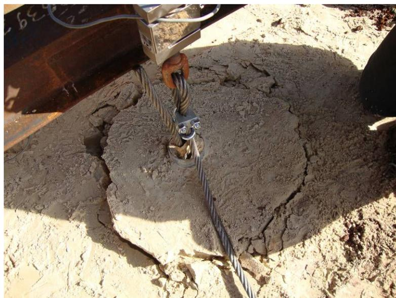
Figura 5.11: Superfície de ruptura circular, ( $D_f = 54,0$  cm) para areia sem cimento, fundação  $D = 30$  cm e  $H/D = 1,0$ , totalmente rompida
