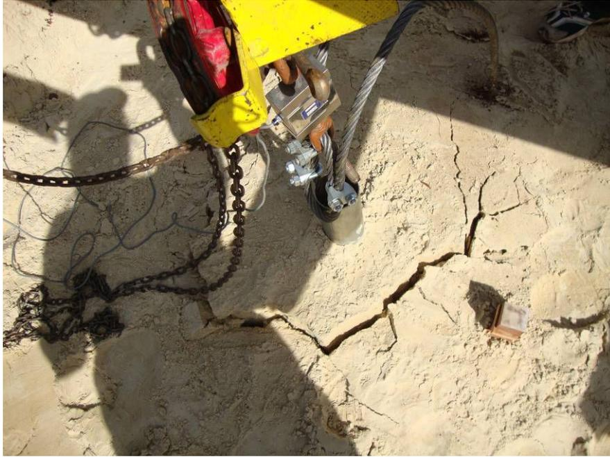
Figura 5.18: Superfície de ruptura circular, ( $D_f = 89,0$  cm) para areia sem cimento, fundação  $D = 45$  cm e  $H/D = 1,0$ , totalmente rompida
