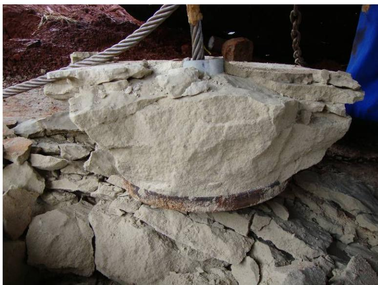
Figura 5.43: Vista lateral do reaterro de areia com 3% de cimento totalmente rompido, para a fundação  $D = 30$  cm e  $H/D = 0,5$  (seqüência 1)
