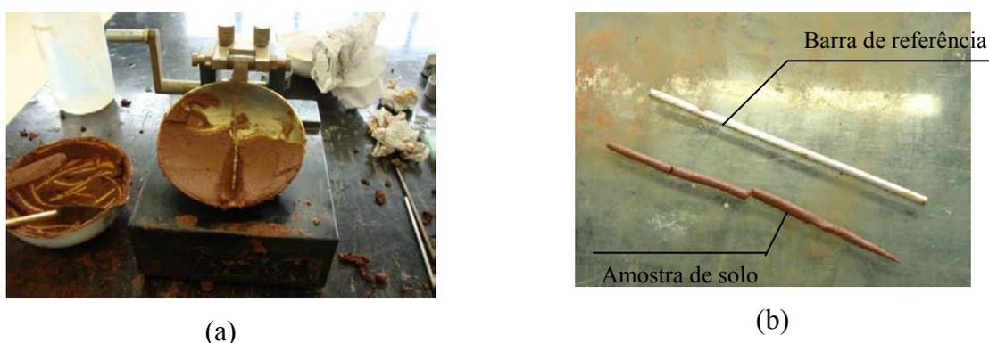
Figura 3.20: Instrumentos empregados para os ensaios de determinação dos limites de consistência – (a) aparelho de Casagrande e (b) placa de vidro e barra metálica de referência
