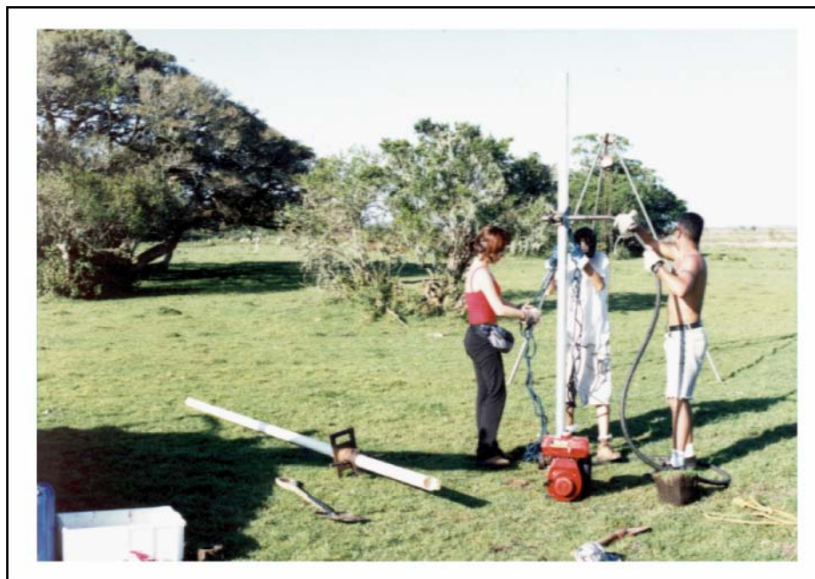
Figura 41 - Testemunho (CP-04) sobre o terraço lagunar holocênico, utilizando um testemunhador Vibracore .
