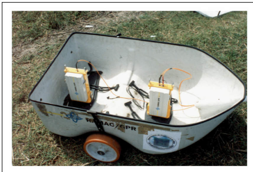
Figura 30 - Disposição das antenas de transmissão e recepção, situadas no interior do barco utilizado para o deslocamento das mesmas. Espaçamento entre as antenas de 60 cm.
