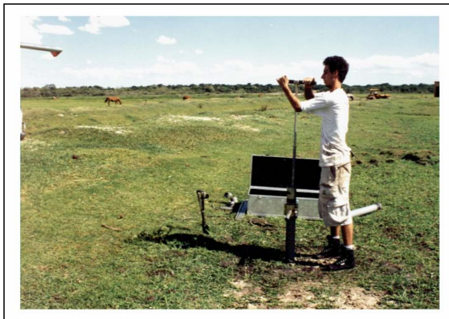
Figura 43 - Testemunho sobre o terraço lagunar holocênico, próximo à margem da Laguna dos Patos, utilizando um testemunhador Eijkelkamp .
