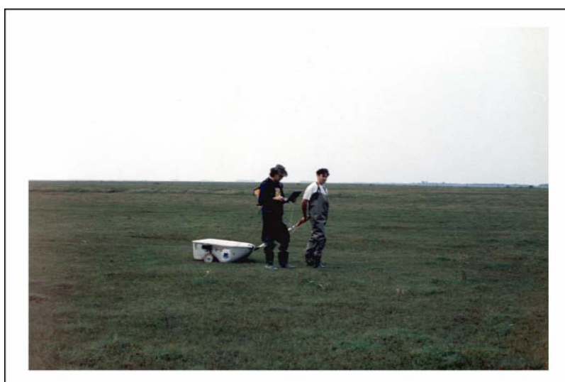
Figura 28 - Sistema de aquisição do perfil geofísico. A unidade controladora e o notebook são operados por um técnico, enquanto outro desloca o barco com as antenas.
