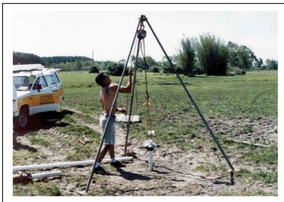
Figura 42 - Retirada da seção testemunhada com o auxílio de uma talha. Terraço pleistocênico (testemunho CP-01).
