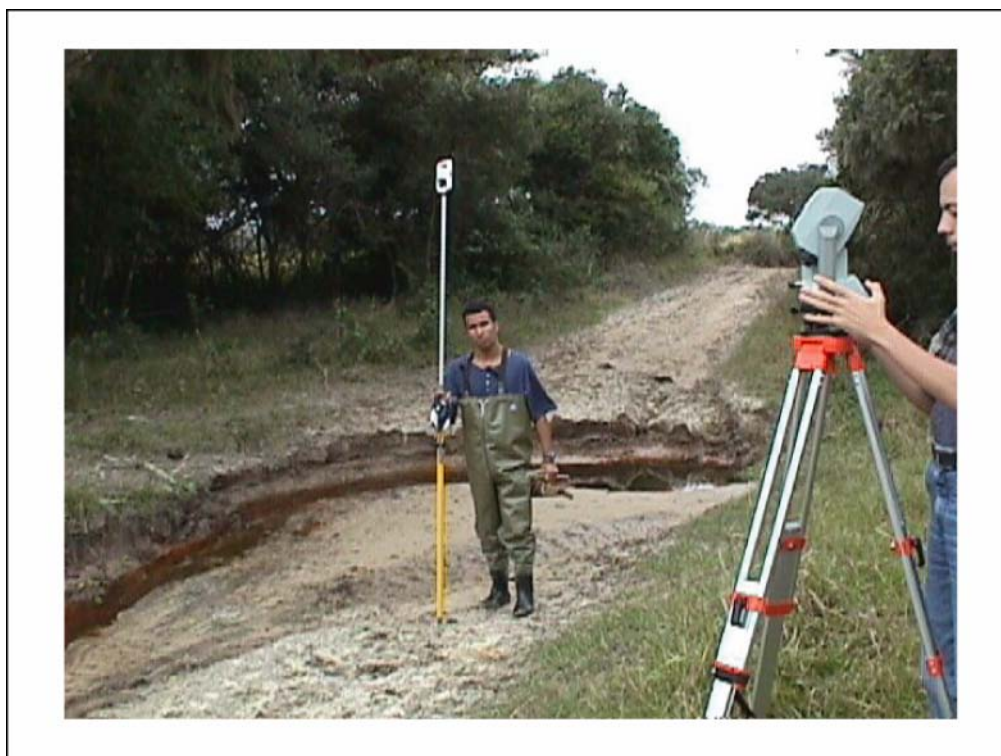
Figura 17 - Sistema utilizado em campo, constando da estação total "Zeiss" e uma baliza com um prisma de espelhos operada por dois técnicos.
