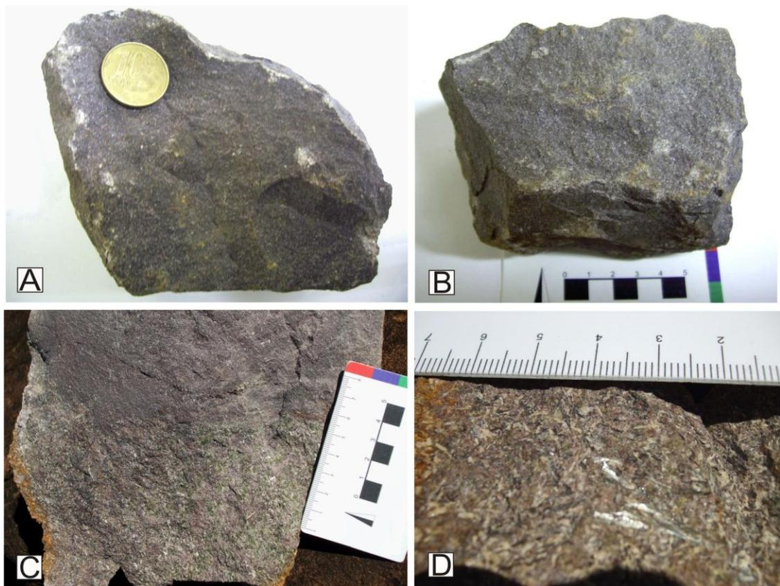
Figura 11 - (A e B): Amostras do diabásio holocristalino e com granulação fina; (C) Bolsão pegmatóide em contato com diabásio de granulação típica. (D) Porção pegmatóide em detalhe mostrando os cristais de piroxênio e plagioclásio.
