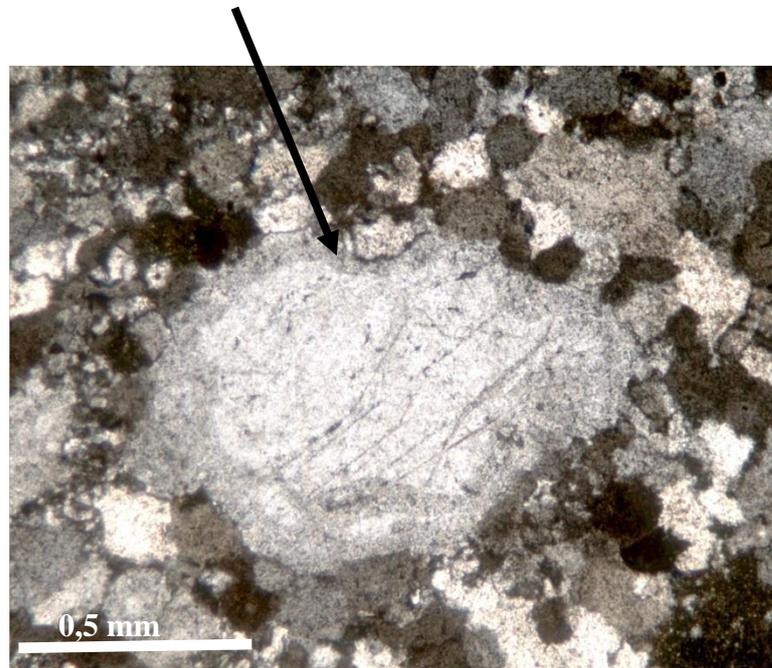
Figura 25. Arenito silicificado (CM 117) apresenta quartzo microcristalino, em mosaico e grãos maiores com bordas de crescimento.
