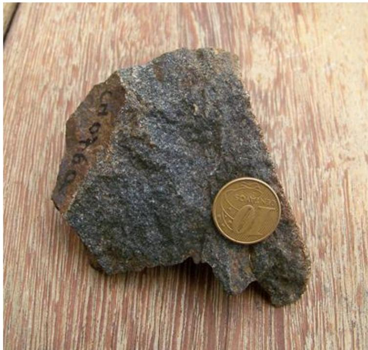
Figura 28. Diabásio hipoabissal da Formação Serra Geral, com textura equigranular fina (ponto CM 076a)
