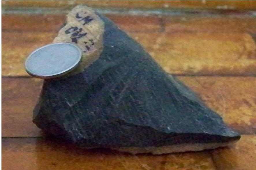
Figura 42. Pelito silicificado (ponto CM 008) com textura muito fina e com estratificação plano-paralela preservada.
