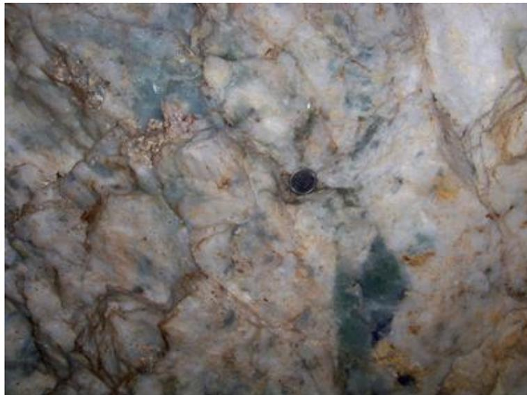
Figura 39. Minério do filão Nova Fátima. A fluorita da fase 2 (verde) está depositada adjunto a calcedônia (branco).
