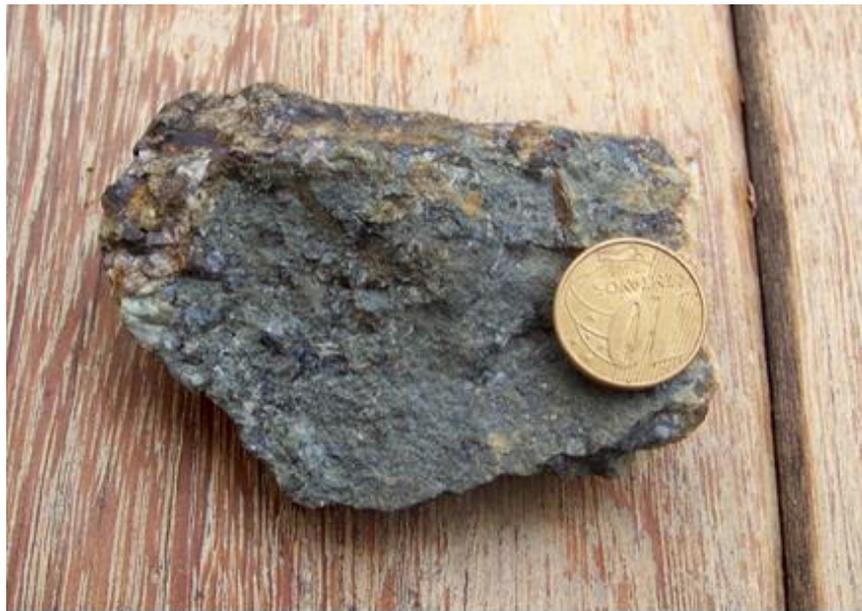
Figura 30. Amostra de quartzo-latito hipoabissal (ponto CM 022a)
