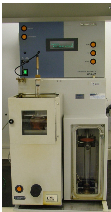
Figura 10: Destilador a pressão atmosférica marca Herzog modelo HDA 627.
