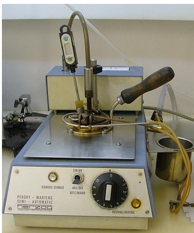
Figura 4: Equipamento Pensky-Martens semi-automático Herzog para ensaio do ponto de fulgor
