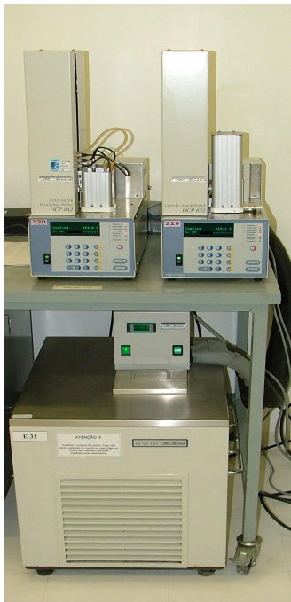
Figura 11: Aparelho para ensaio do ponto de entupimento de filtro a frio marca Herzog modelo HCP 842.
