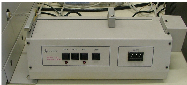
Figura 9: Sistema de injeção da amostra no analisador de enxofre.
