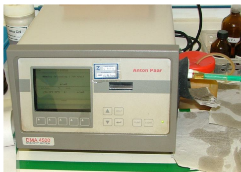
Figura 5: Densímetro digital modelo DMA 4500 marca Anton Paar
