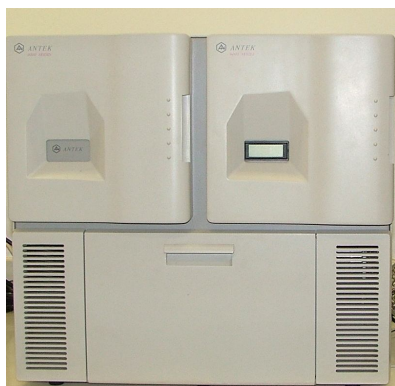
Figura 7: Forno de fluorescência por ultravioleta para ensaio de enxofre total marca Antek modelo 9000S
