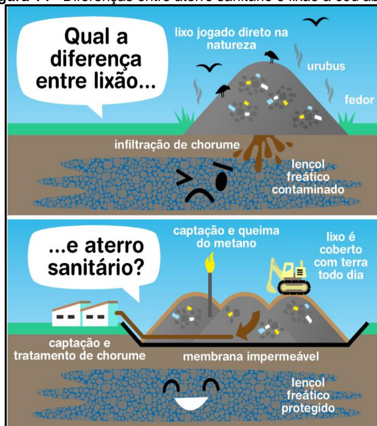
Figura 14 - Diferenças entre aterro sanitário e lixão a céu aberto
