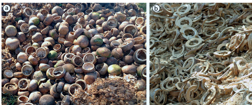
Figura 3 – Resíduos de porongo oriundos da produção de cuias: a) resíduos do primeiro processo de corte; b) resíduos do segundo processo, de corte e lixa.
