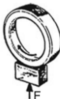
Figura 3.15 Esquema simplificado do contato e funcionamento do ensaio Timken
