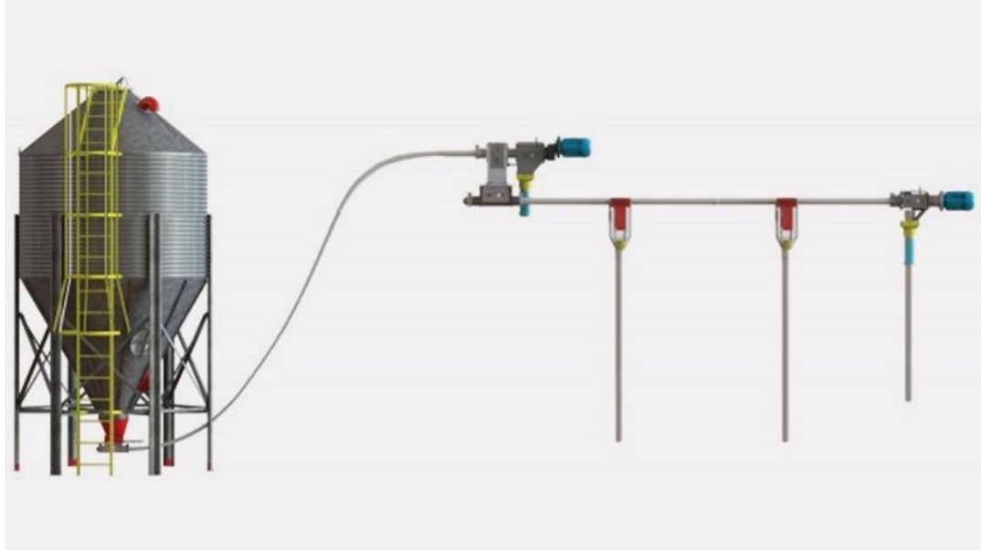
Figura 6. Sistema automático de aração com dosadores tipo drop .
