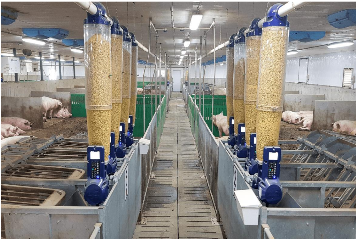
Figura 4. Sistema automático com uso de sistema eletrônico para alimentar matrizes suínas gestantes - Gestal 3G.
