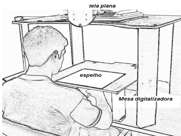
Figura 2. Aparato utilizado para verificar a capacidade de proprioceptiva de sujeitos com DP através da escrita. Adaptado de Contreras-Vidal & Gold (2004).
