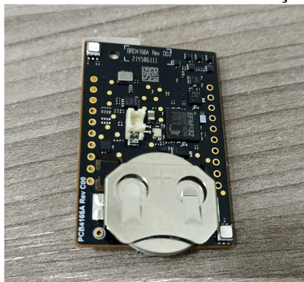
Figura 25 – Demoboard BRD4166A com alimentação por bateria CR2032
