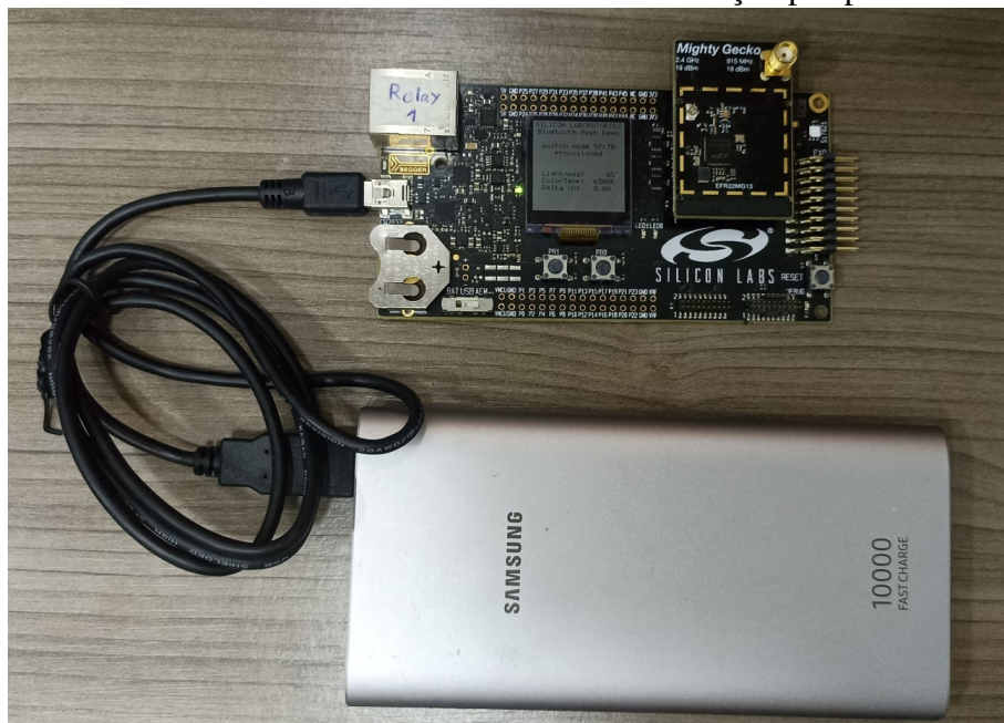
Figura 26 – Demoboard SLWSTK6005A com alimentação por powerbank USB
