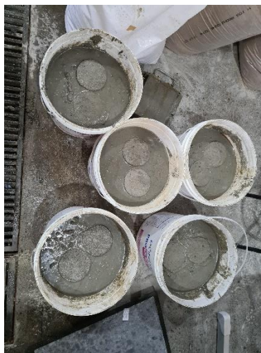
Figura 79: Confeção da proteção térmica às laterais dos CPs
