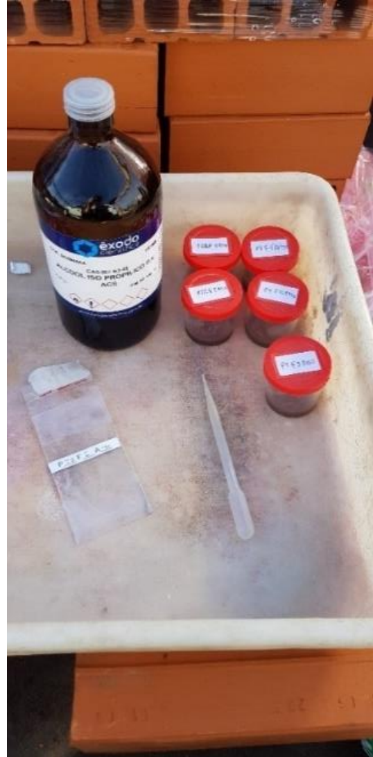
Figura 60 - Paralisação da hidratação
