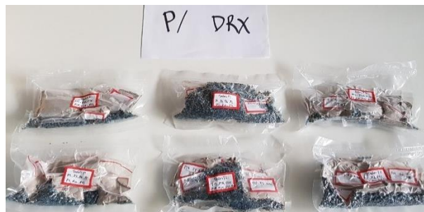
Figura 64 - Selagem a vácuo das amostras para DRX
