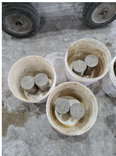
Figura 78: Confeção dos CPs cilíndricos (10x20 cm)
