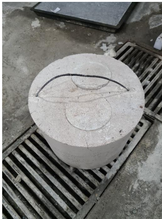
Figura 86: Resfriamento à temperatura ambiente e sem água (amostras secas)
