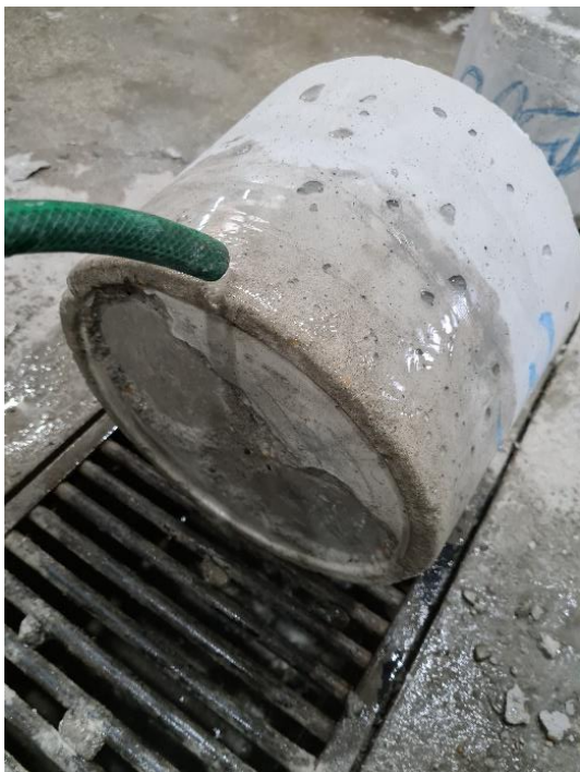
Figura 85: Resfriamento com água corrente (amostras de pó “molhadas”)
