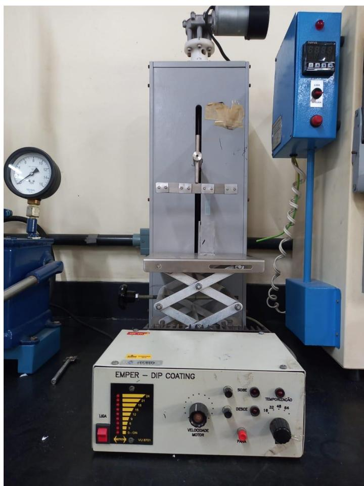
**Figura 4:** Equipamento *Dip-coating* utilizado
