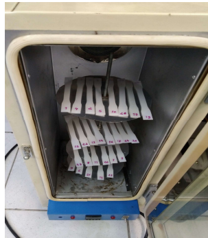
Figura 2 - Secagem das amostras por 24h no forno à 50°C
