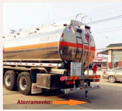
Aterramento Figura 1 - Aterramento anti eletricidade estática
