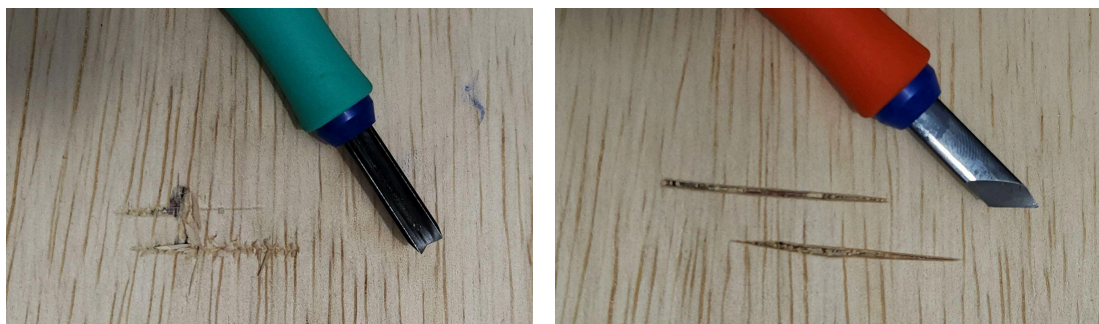
figuras 26 e 27 corte contra os veios com a goiva em V e corte contra os veios com a goiva faca
