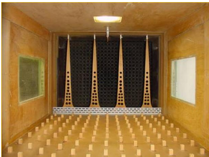
Figura 3.3: Blocos disseminados no piso e gaveta colocada no início da câmara de ensaios do túnel de vento para representação do vento natural.
