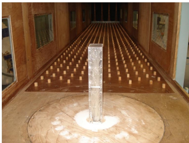
Figura 4.1: Modelo CAARC instrumentado com tomadas de pressão para fins de aplicação da técnica HFPI .
