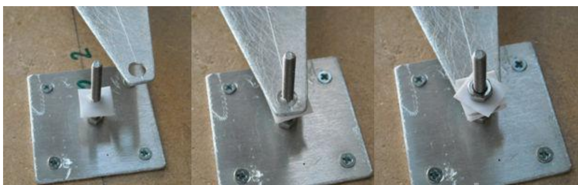
Figura 3.16: Detalhe da fixação no mecanismo de apoio com lâminas de teflon para minimizar o atrito, resultando na diminuição da rigidez rotacional.
