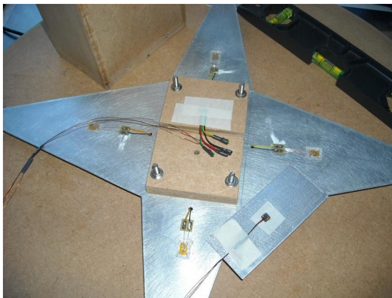
Figura 3.21: Instrumentação na base da célula de carga com extensômetros (lado superior).
