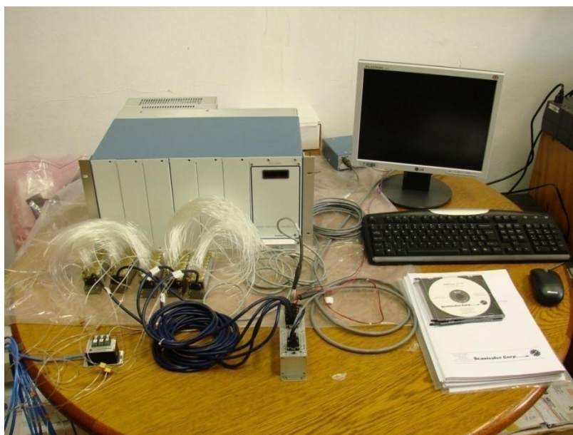
Figura 3.5: Sistema eletrônico de medição dinâmica de pressões do LAC/UFRGS.
