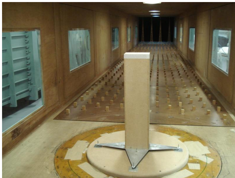
Figura 4.3: Dispositivos utilizados nos ensaios para simulação das características naturais do vento, juntamente com o modelo CAARC instalado sobre a base flexível.
