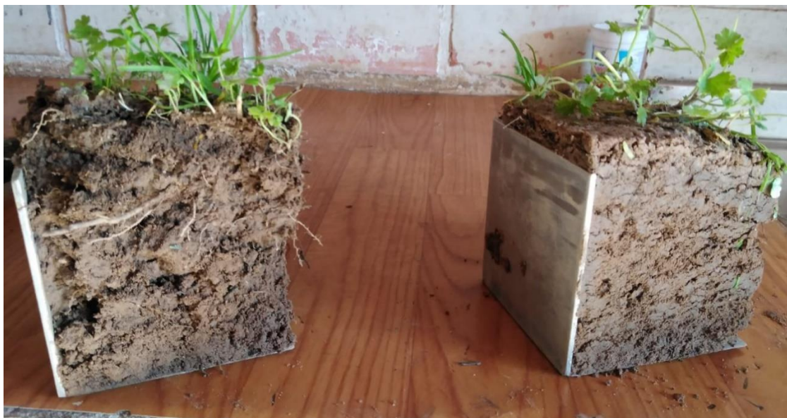
Figura 12. Aparelhos cúbicos de aço inox para extração de amostras de solo e raízes.
