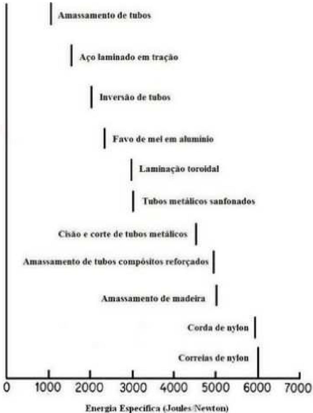
Figura A.49 - Energia específica de alguns absorvedores de impacto
