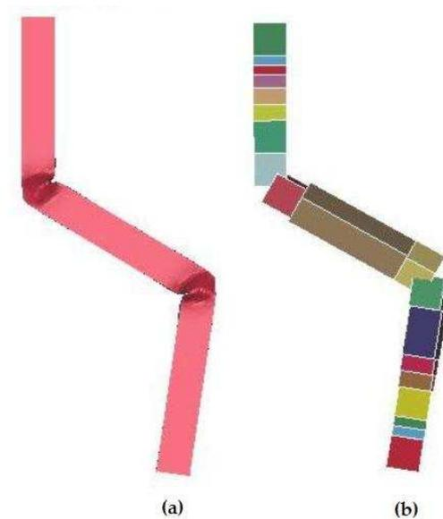
Figura 5.13 - Deformadas (a) MEF; (b) Simplificado
