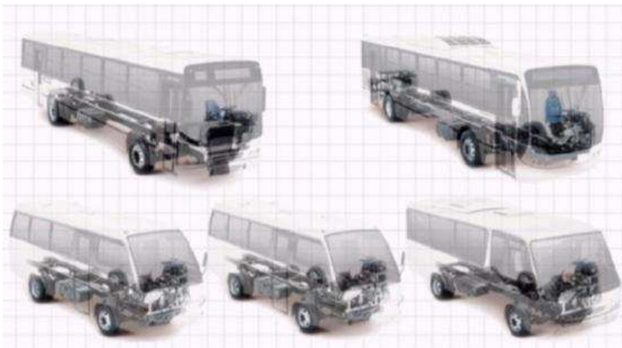
Figura B.1 - Carroceria montada sobre o chassi
