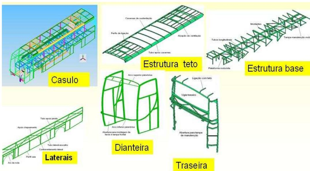
Figura B.16 - Detalhes da carroceria.
