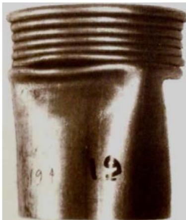
Figura A.25 - Amassamento estático e dinâmico de um tubo cilíndrico de parede fina
