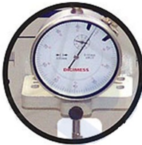
Figura 39: Medidor de Deslocamento em detalhe no kit Fonte: (CIDEPE, 2009)
