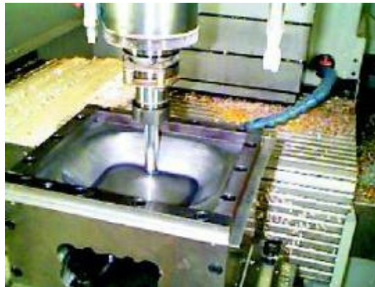
Figura 3.9 - Processo de Estampagem Incremental (Mcloughlin, 2005).
