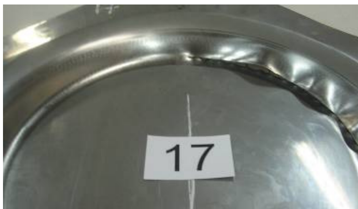
Figura 6.6 - Superfície estampada rompida no ensaio nº 17.
