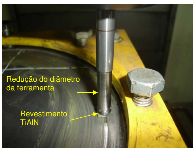
Figura 6.27 - Ferramenta em trabalho no ensaio n° 45.
