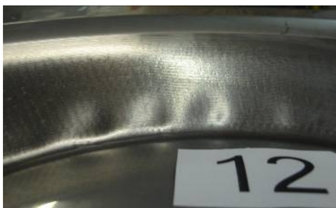
Figura 6.7 - Enrugamento da superfície estampada ensaio nº 12.
