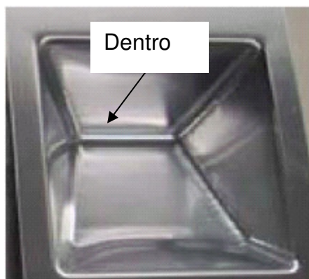
Figura 3.25 - Peça fabricada pelo processo de Estampagem Incremental, mostrando o ângulo de dobramento interno menor que 90^\circ (Alwood et al., 2005).
