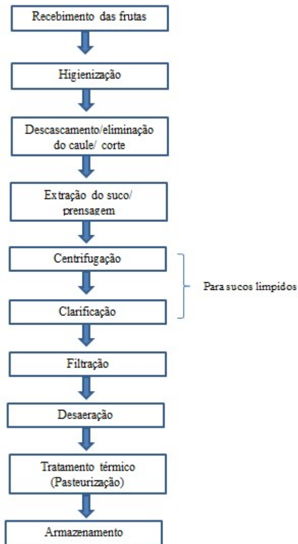
Figura 2. Produção de suco natural de fruta usando processos convencionais. Adaptado de Vatai, 2010.
