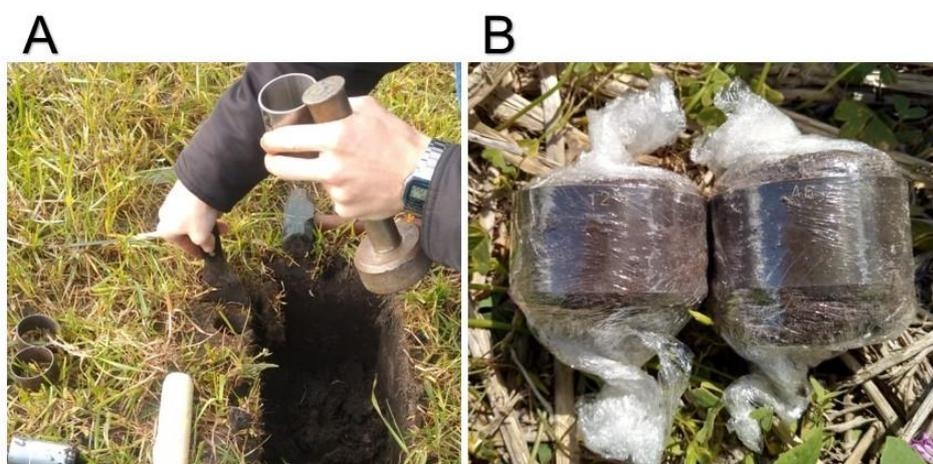
**Figura 6.** Momento da coleta das amostras de solo na trincheira (A); amostras indeformadas de solo já embaladas, para análises físicas de umidade, porosidade e densidade (B). Imagens: o autor.
