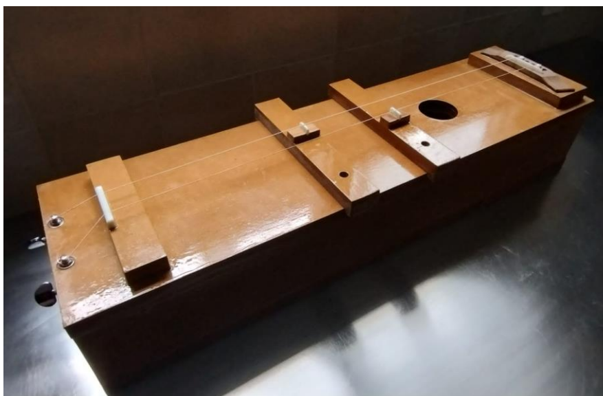
Figura 3.3 – Monocórdio finalizado, já com os cavaletes móveis.
