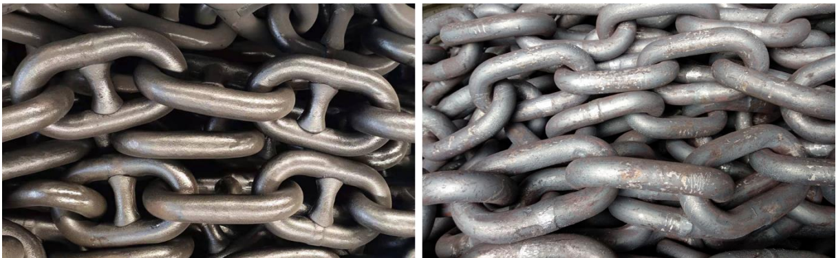
Figura 2.5 – Ilustrações reais dos elos do tipo studlink (à esquerda) e studless (à direita).
