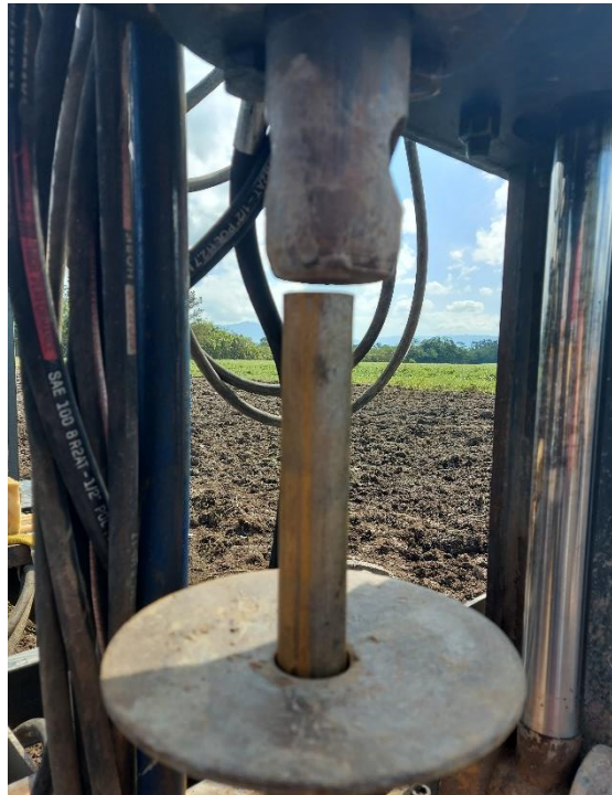
Figura 3.16 – Detalhe da folga de 5 mm entre equipamento de cravação e haste, antes da aplicação de carregamento.
