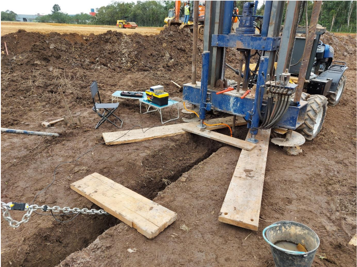
Figura 3.15 – Configuração do ensaio: equipamento de cravação restringe o deslocamento da haste enquanto o carregamento é aplicado na extremidade livre da corrente.
