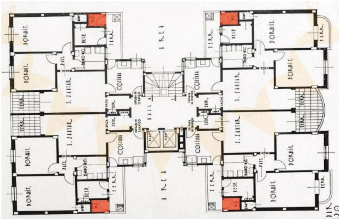
**Figura 22:** Planta-baixa do pavimento tipo do Edifício Elza (São Paulo-SP). Aqui um cômodo que aparece com a indicação "Despensa" está posicionado no lugar que normalmente assume a função de quarto de empregada (na área de serviço, posterior à cozinha e ao lado do banheiro de empregada, ressaltado em vermelho). Fonte: Revista Acrópole n° 60 (1943, p. 434) adaptada pela autora.
