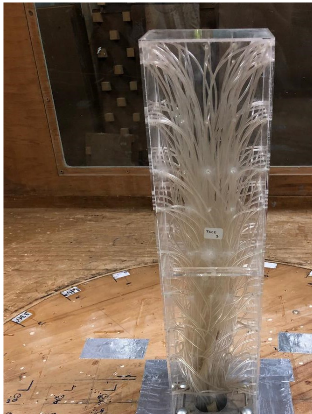
Figura 5.1: Modelo I na mesa II do Túnel de Vento prof. Joaquim Blesmann (fonte: autora)
