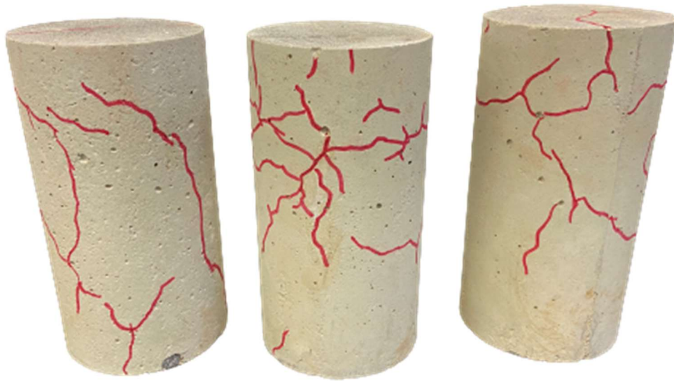
Figura 41 – Fissuras no CC após elevada taxa de aquecimento
