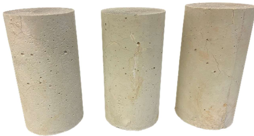
Figura 38 – Análise de spalling do CC
