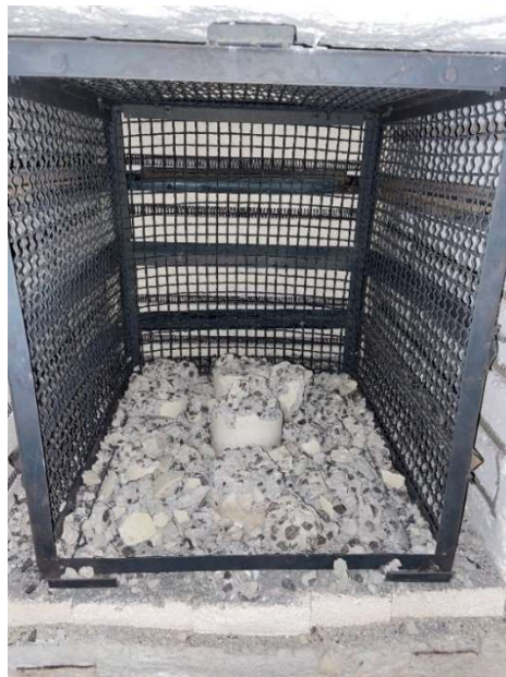
Figura 39 – Análise de spalling do CAA
