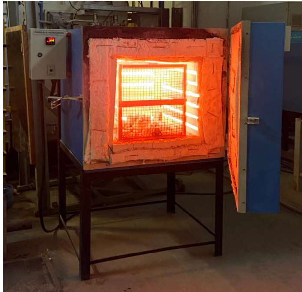
Figura 15 – Forno elétrico industrial utilizado na pesquisa
