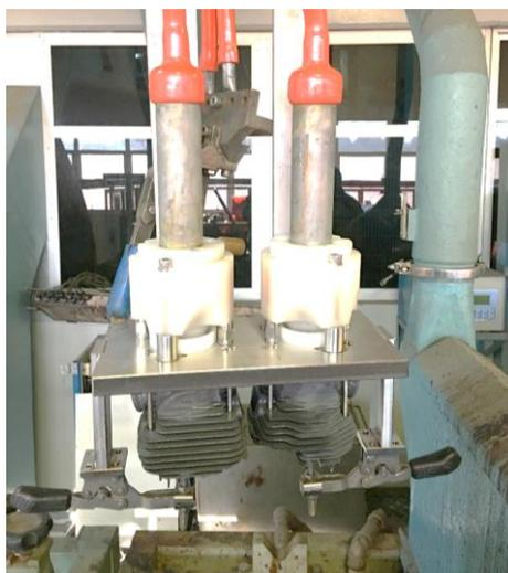
Figura 19: Fixação com cilindros montados no dispositivo para ser submerso no banho de cromo.
