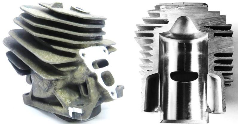
Figura 3: Cilindro de um motor à combustão interna de ciclo de operação 2 tempos. Camisa do cilindro apresentado à direita com o cilindro em corte. Fonte: Autor.
