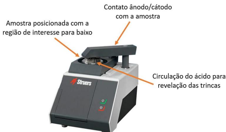
Figura 21: Máquina de polimento eletrolítico utilizada para revelação das trincas da camada de cromo da superfície de deslize de amostras de cilindros. Fonte: Fabricante Struers Ensuring Certainty.
