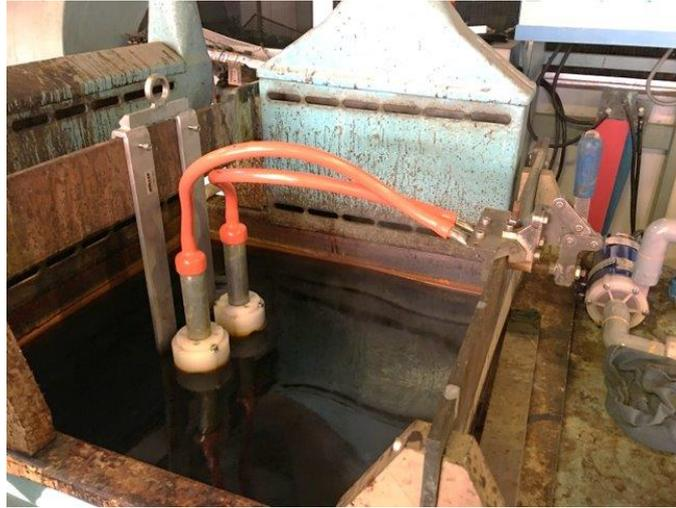
Figura 20: Dispositivo submerso no banho de cromo com o polo positivo e negativo para o fechamento do circuito do processo de eletrodeposição.
