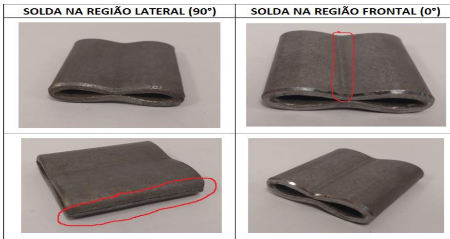
Figura 54: Ensaio de achatamento sem deformações relativas do diâmetro externo ( \epsilon D_1 ).
