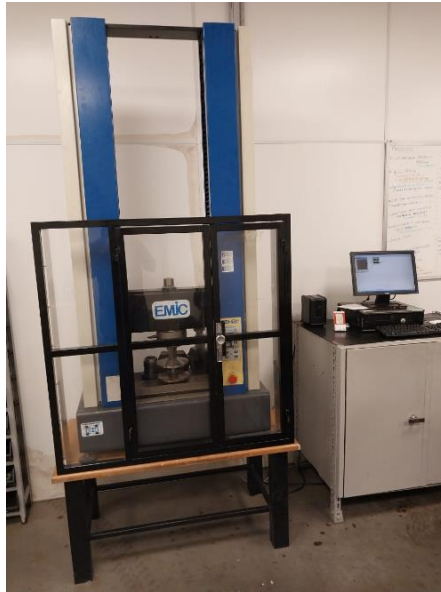
Figura 28: Máquina universal de ensaio EMIC DL 1000 .
