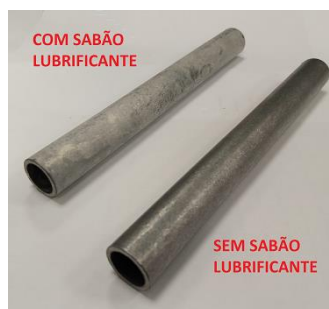
Figura 23: Tubos com e sem sabão lubrificante.
