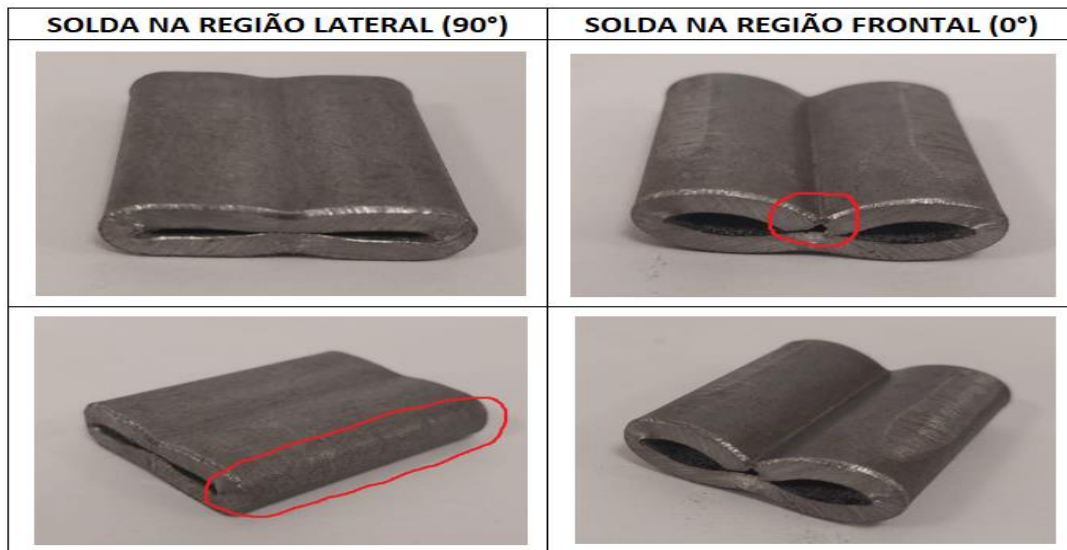
Figura 58: Ensaio de Achatamento com 20% de deformação relativa do diâmetro externo ( \epsilon D_1 ).
