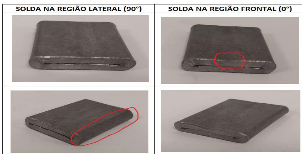
Figura 60: Ensaio de Achatamento com 25% de deformação relativa do diâmetro externo ( \epsilon D_1 ).
