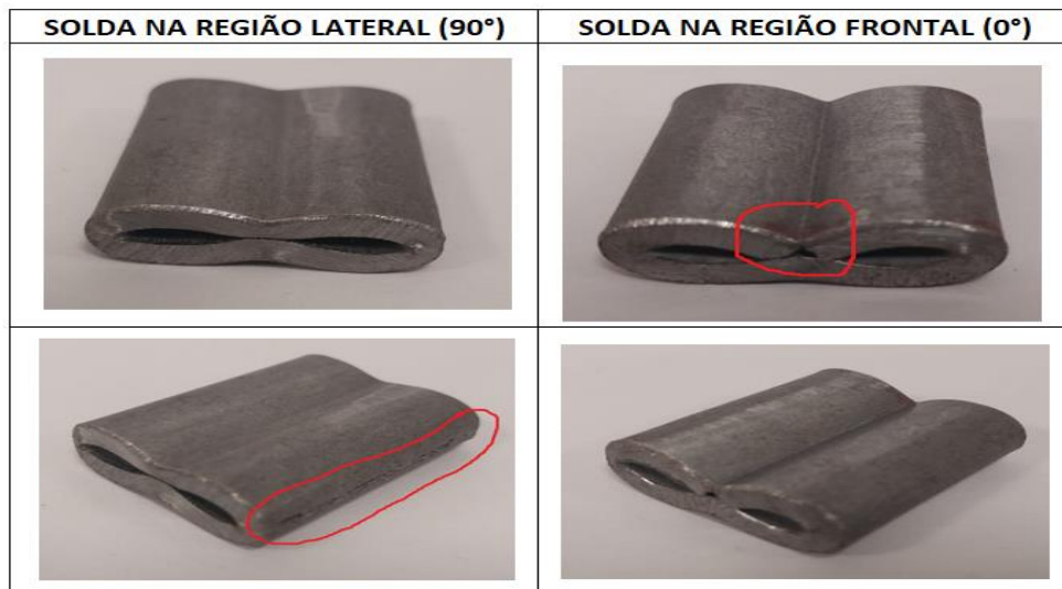
Figura 56: Ensaio de Achatamento com 15% de deformação relativa do diâmetro externo ( \epsilon D_1 ).
