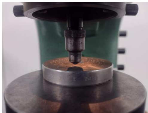
Figura 30: Calibração do durômetro.
