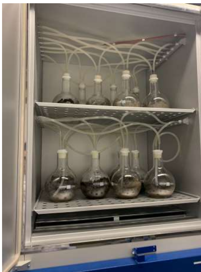
Figura E.3 – Estufa com vasos de biodegradação, vista interna
