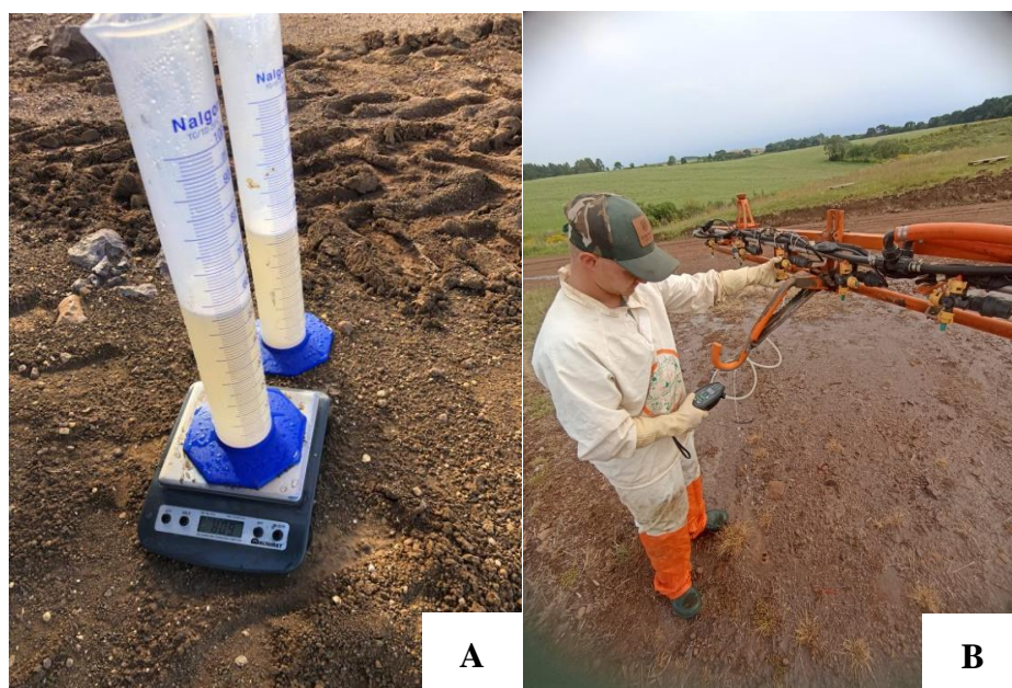
Figura 4 – Detalhamento da verificação da vazão das pontas com provetas (A) e com uso do fluxômetro digital (B)
