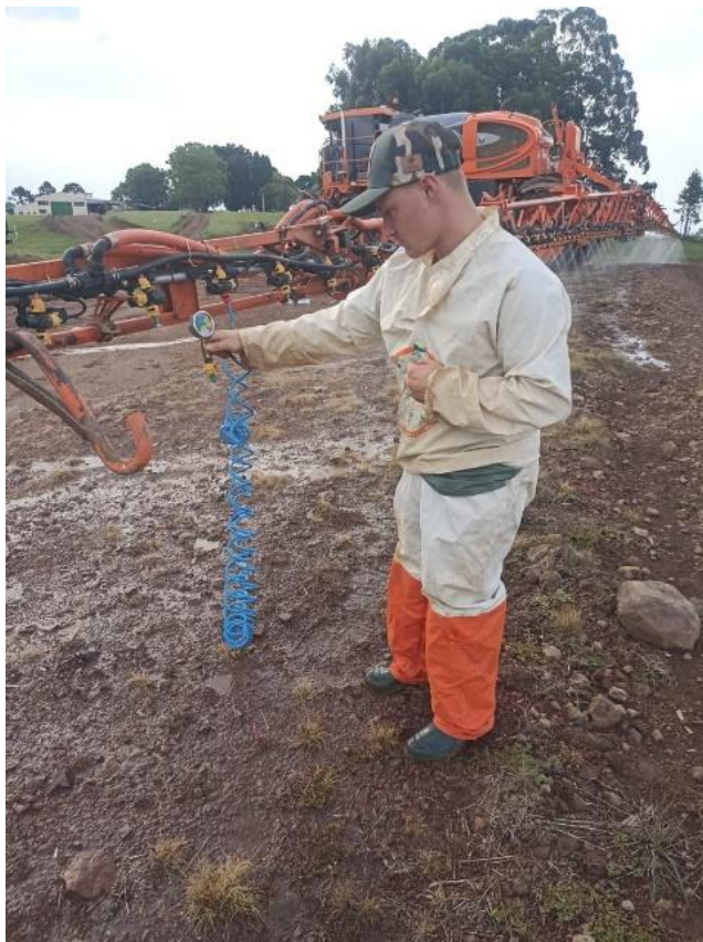
Figura 3 – Detalhe da aferição da pressão hidráulica no barramento de pulverização
