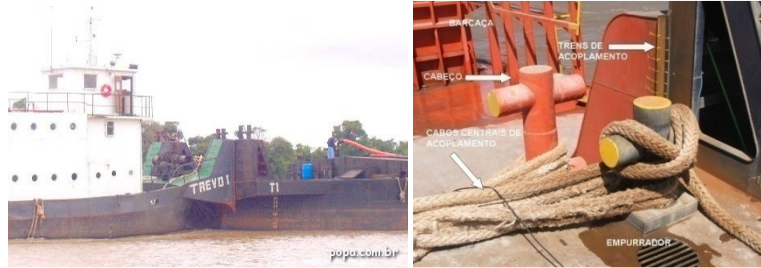
Figura 2.3 – Conjunto Empurrador-Barcaça acoplado através de cabos.
