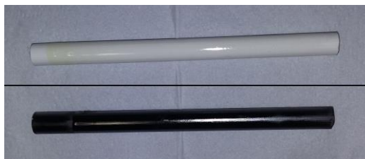
Figura 1 - Imagem das membranas suportadas polimérica (clara) e de carbono (escura) suportadas
