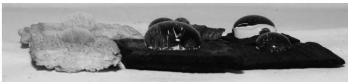
Figura 6 - Comportamento Hidrofóbico da Biomassa Torrefada
