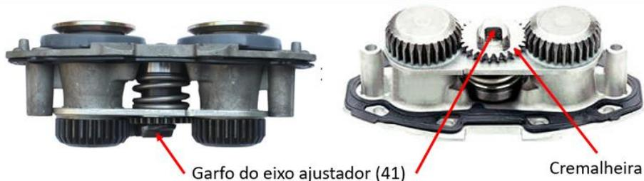
Figura 2.6 – Mecanismo de ajuste de freios Meritor – ELSA 225 [Fonte: o autor, adaptado de MERITOR, 2016.]
