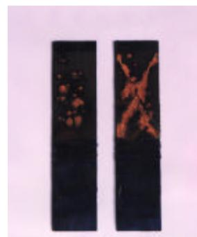
**Figura 1** – Ensaio de névoa salina após 5 horas de exposição de filmes de PPy. Lado esquerdo, amostra sem entalhe; lado direito, amostra com entalhe em X.
