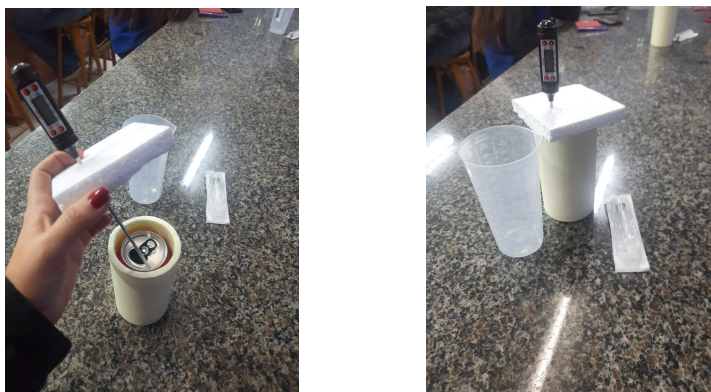
Figura 8 - Calorímetro confeccionado pela professora.
