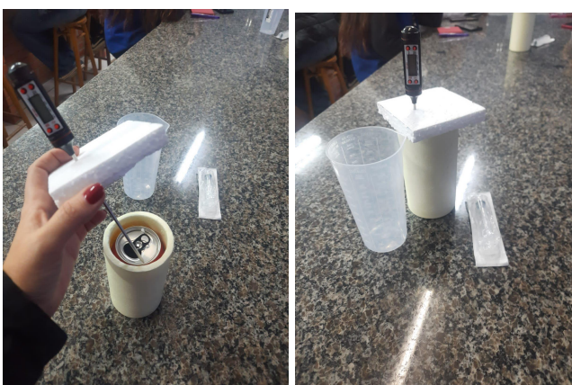
Figura 15 – Calorímetro confeccionado pela professora
