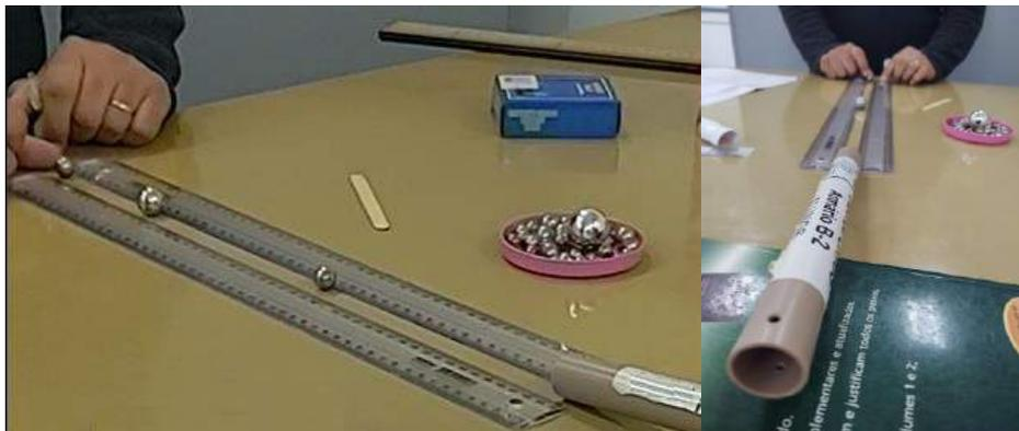
Fixem as régulas na mesa com auxílio de uma fita dupla face, mantenha as régulas paralelas e 2 cm de distância entre si. Após, posicionem o tubo de pvc na ponta da régua, onde a graduação do instrumento marca 0 ou 60 cm, para elevar o cano use de um a dois livros como apoio. Terminada a montagem seu grupo irá receber 5 esferas de aço.
