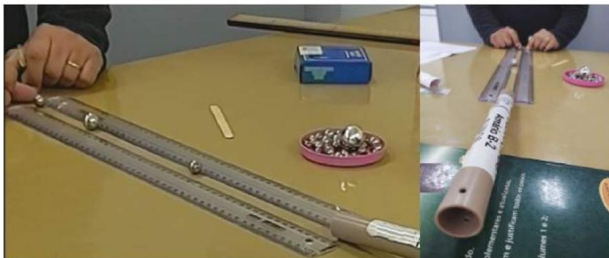
Fixem as régua na mesa com auxílio de uma fita dupla face, mantenha as régua paralelas e 2 cm de distância entre si. Após, posicionem o tubo de pvc na ponta da régua, onde a graduação do instrumento marca 0 ou 60 cm, para elevar o cano use de um a dois livros como apoio. Terminada a montagem seu grupo irá receber 5 esferas de aço.
