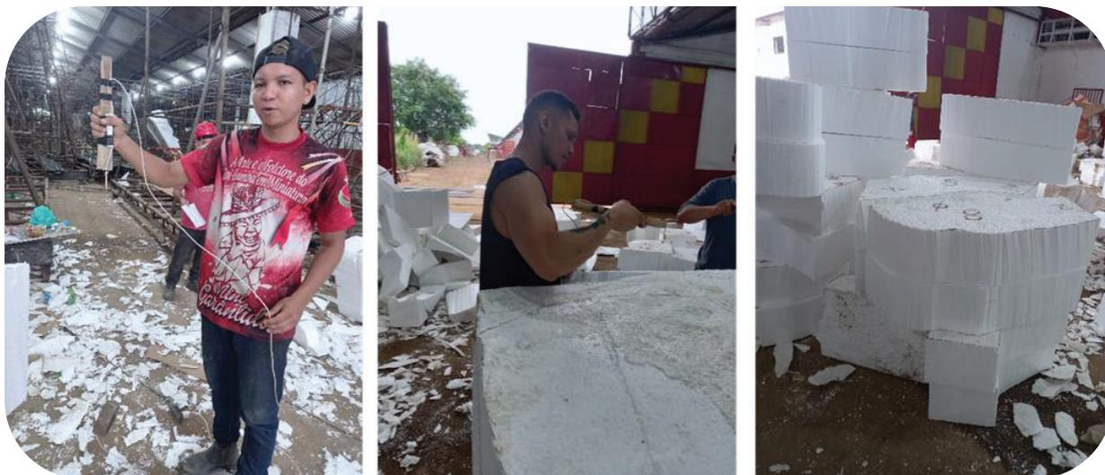
Figura 55 - Extensão e corte dos blocos de isopor
