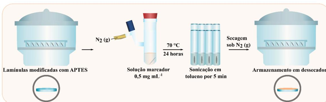
**Figura 13. Ilustração de etapas envolvidas na estratégia de verificação do filme de APTES por sinalização com composto fluorescente: i) exposição de lamínulas modificadas com APTES à solução do composto utilizado como marcador, em tolueno, a  $70 \text{ }^\circ\text{C}$ , sob atmosfera de nitrogênio; ii) remoção de excesso de marcador por lavagem em tolueno assistida por ultrassom; iii) estocagem em ambiente com umidade reduzida.**
