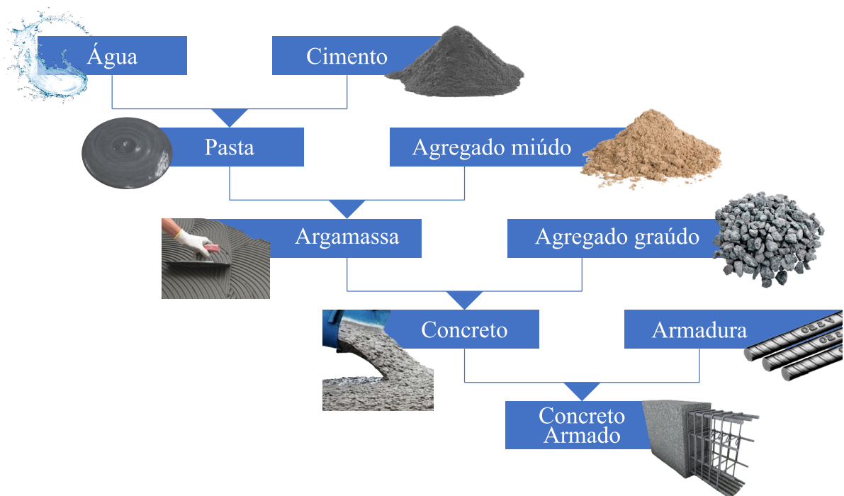
Figura 2.1 – Fluxograma resumo da produção do concreto armado.
