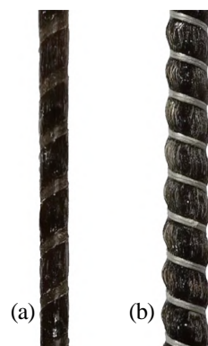
Figura 2.20 – Barras de BFRP utilizadas no ensaio de pull-out de Bueno: (a) 8mm e (b) 12,5 mm.
