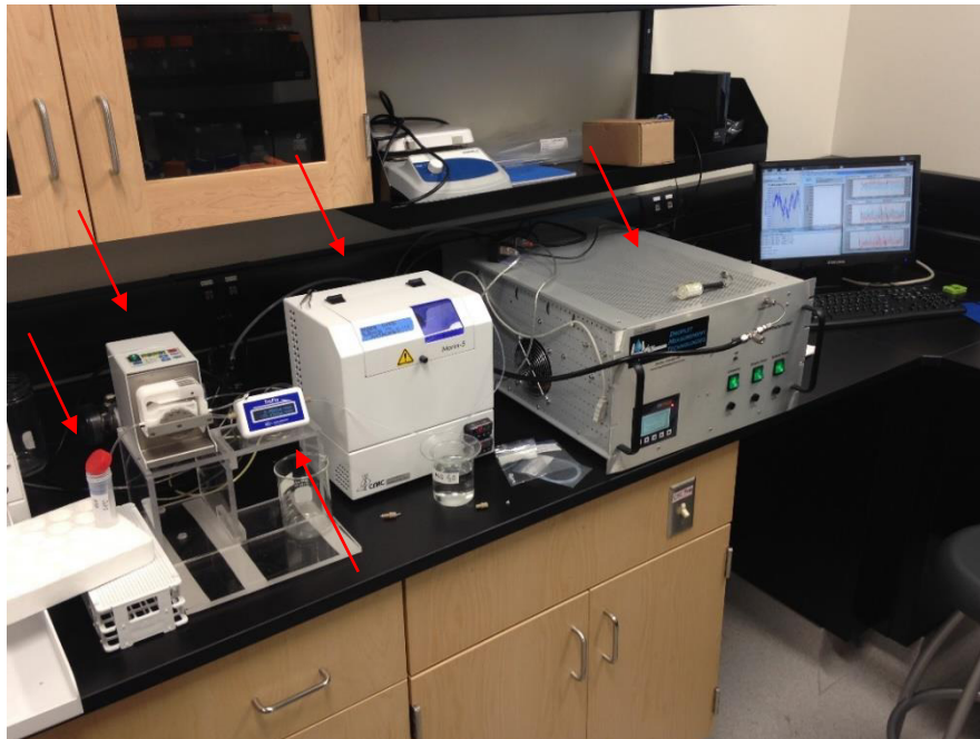
Figura 40. Análise de amostra líquida no SP2. Da esquerda para a direita: Amostra líquida; bomba peristáltica; monitor de fluxo TruFlo; Nebulizador Marin-5; SP2.
