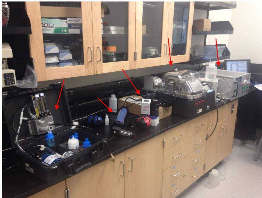
Figura 32. Processo de calibração interna do SP2. Setas indicam, da esquerda para a direita: Nebulizador próprio para a calibração interna, dessecador, neutralizador de cargas (aparelho de raios-X), CMPA e SP2.
