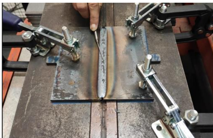
Figura 28 - Formato do corpo-de-prova após a realização da soldagem.
