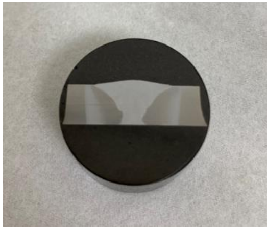
Figura 37 – Amostra da região soldada após procedimento de preparo.
