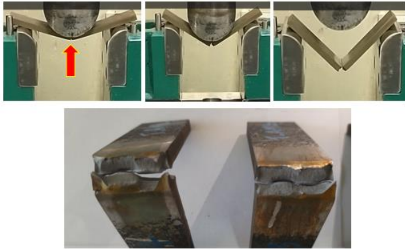
Figura 69 - Ensaio de dobramento para o material estampado e soldado sem pré-aquecimento (HF_Soldado_AMB), e corpo-de-prova pós-ensaio.
