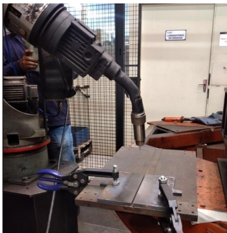
Figura 27 – Esquema utilizado para a realização da união das chapas metálicas.
