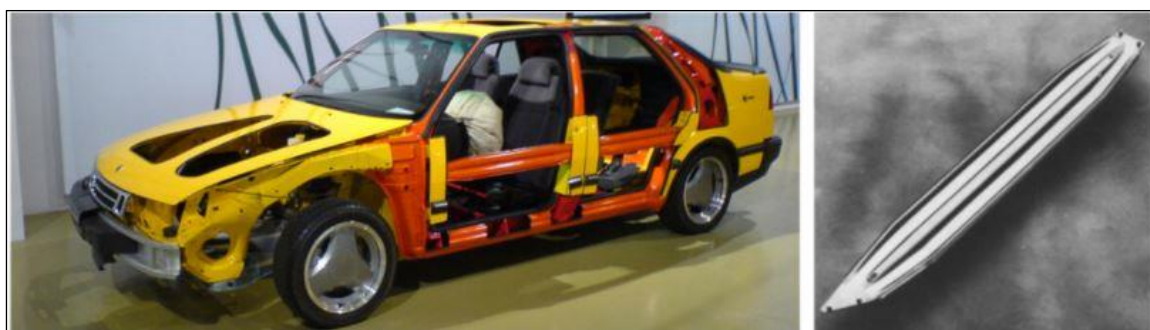
Figura 2 - Viga da porta do Saab 9000 de 1984 a 1998, estampada a quente.
