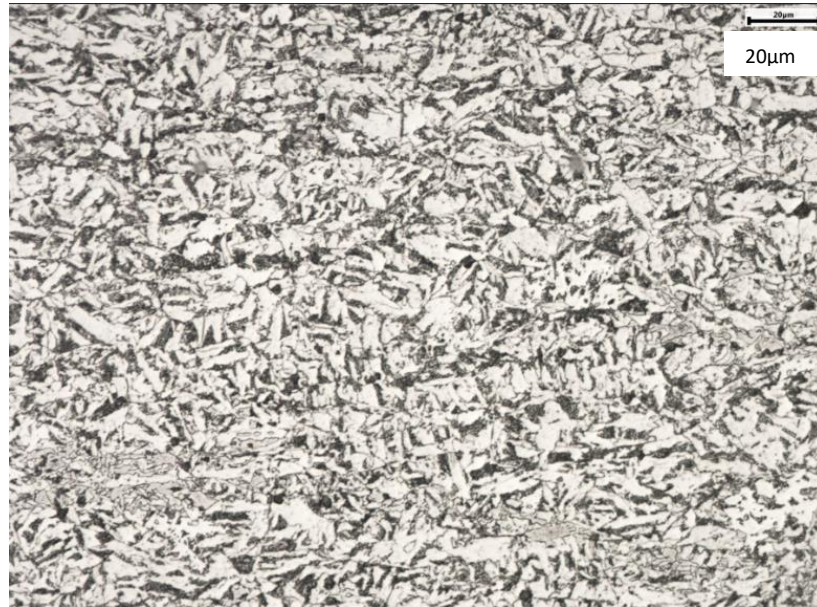
Figura 42 - MEV do aço 22MnB5 + Nb e Mo, conforme entregue.
